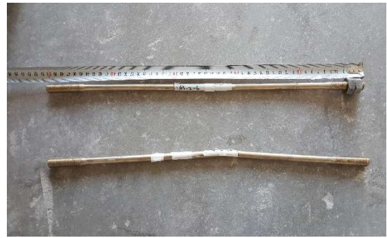
(d) View of CuAlMn 1&2 after the test
