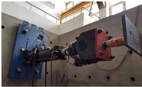
(a) Hydraulic MTS actuator
