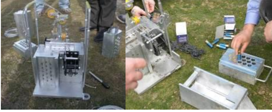
Şekil 4.4 S Gun sismik enerji kaynağı (Ecevitoglu ve Aldaş, 2011)
