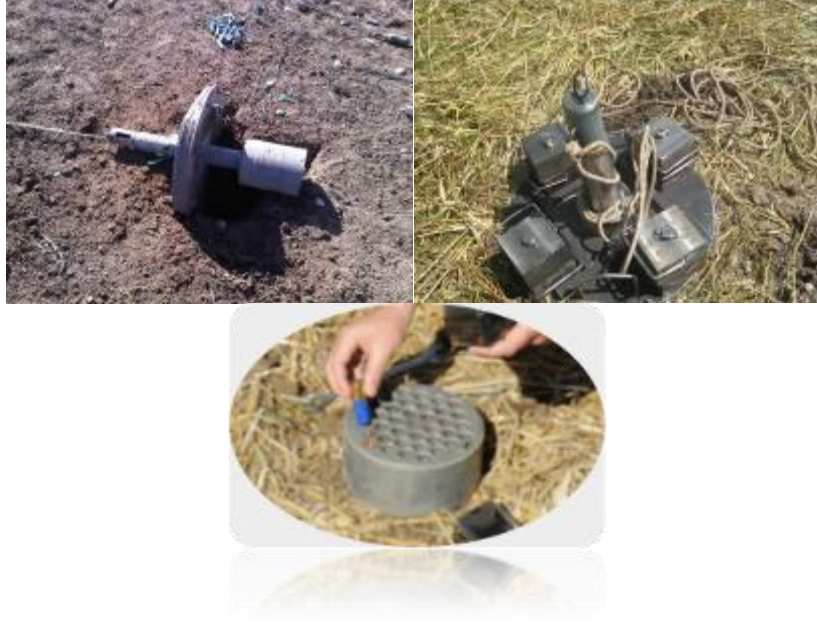
Şekil 4.5 P gun sismik enerji kaynađı (Canyaran ve Ecevitođlu, 2011)
