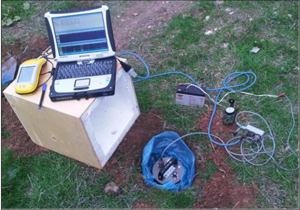
Şekil 4.14 Guralp CMG-6TD kayıtçı sisteminin arazide yerleştirilmesi ve veri kaydı alınmasından bir görüntü
