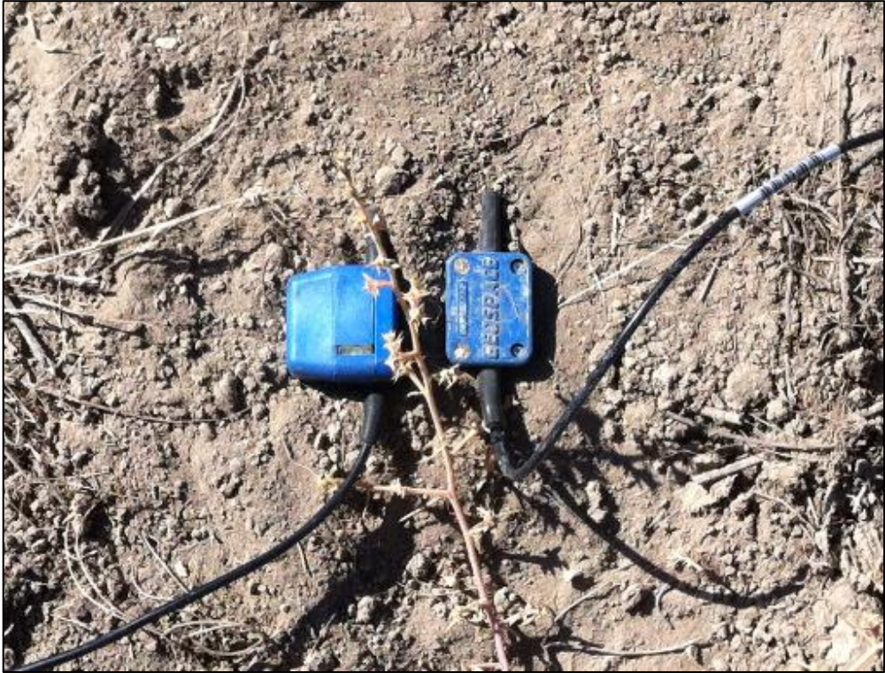
Şekil 4.9 S jeofonu (solda) ve P jeofonu (sağda)
