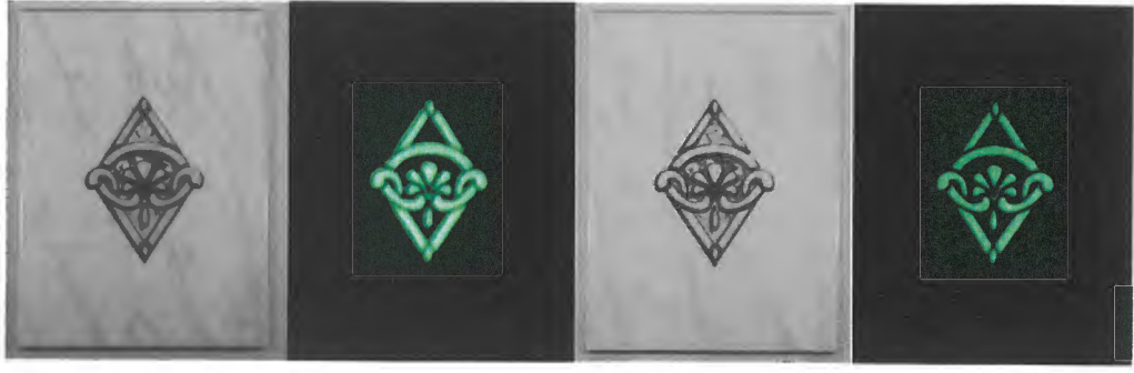
Şekil 13.16. VitroA Karo A.Ş.'de 920 °C'de (a) 40 dk ve (b) 35 dk süreyle pişirimi yapılan sarımsı-yeşil ışıdamalı duvar kerosu bünyelerine ait aydınlık ve karanlık ortam görüntüleri.
