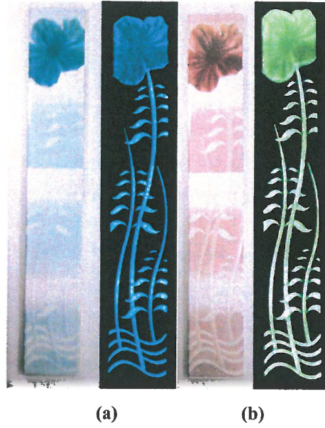
Şekil 13.3. Termal Seramik A.Ş.'de S1B kodlu firitin kullanımıyla gerçekleştirilen uygulamalara ait aydınlık ve karanlık ortam görüntüleri, (a) % 10 mavimsi-yeşil pigment (b) % 10 sarımsı-yeşil pigment.
