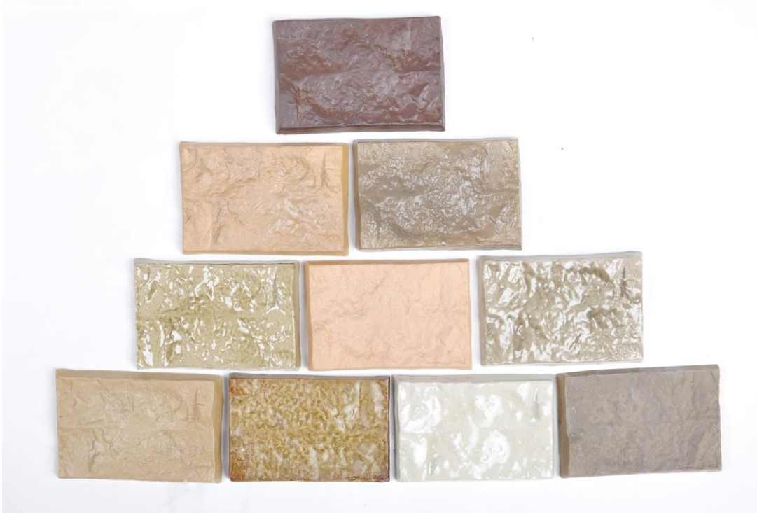
Görsel 3.31. DÖKÜM4, KAO4, O. FRİT4, S. FRİT3, SODA4, SÜL2, ŞAMOT3, TİTAN2, TİTAN3, TİTAN4 kodlu dikdörtgen seramik duvar panosu elemanları, 1200°C, 2x9,8x14,5 cm (Göksel, 2020)
