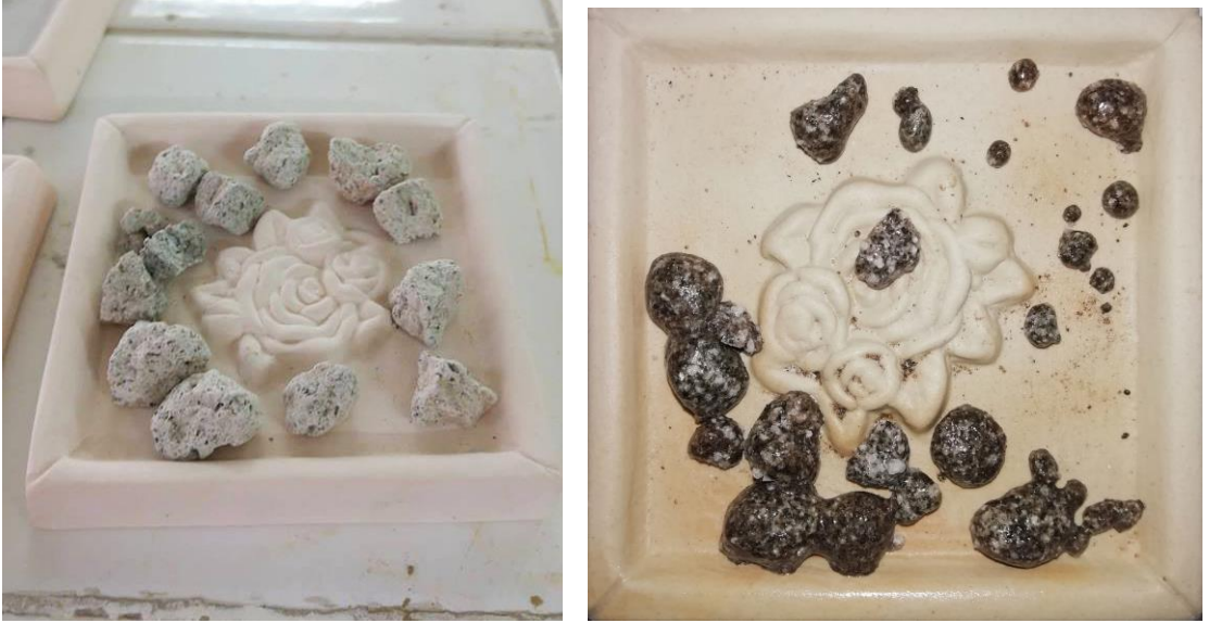
Görsel 3.2. 10-20 mm boyutlarındaki pomza taşları ve 1200°C pişirim sonuçları
