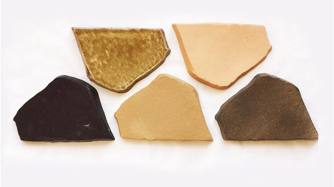
Görsel 3.35. KINIK2, KO2, KU3, TİTAN2, TİTAN5 kodlu duvar panosu elemanları, 1200°C, 2x11x16,7cm (Göksel, 2020)
