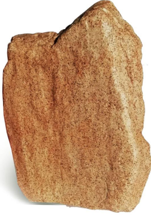
Görsel 3.7. DÖKÜM5 kodlu deneme çamuru ile yapılmış form, 1200°C, 1,6x8,7x11 cm (Göksel, 2020)
