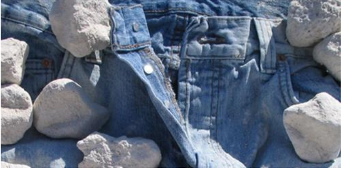
Görsel 2.6. Pomza taşları ile kot taşlama işlemi
