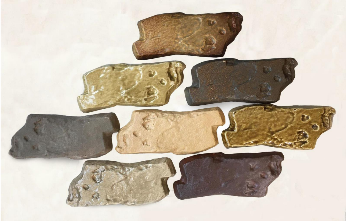
Görsel 3.29. KAO 4 , KAR 2 , KO 1 , S. FRİT 3 , SODA 4 , SÜL 2 , ŞAMOT 3 , TİTAN 2 kodlu seramik duvar panosu elemanları, 1200°C, 1,8x7x16 cm (Göksel, 2020)
