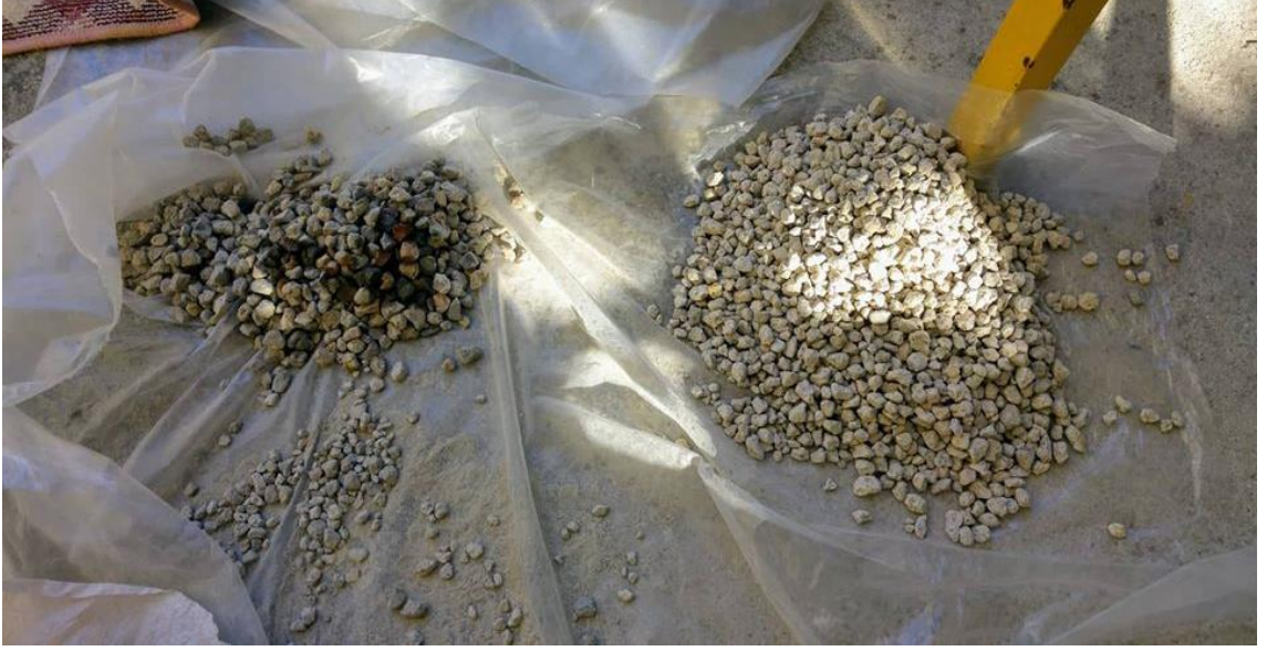
Görsel 3.1. Pomza taşlarının içindeki yabancı taşların ayrılması
