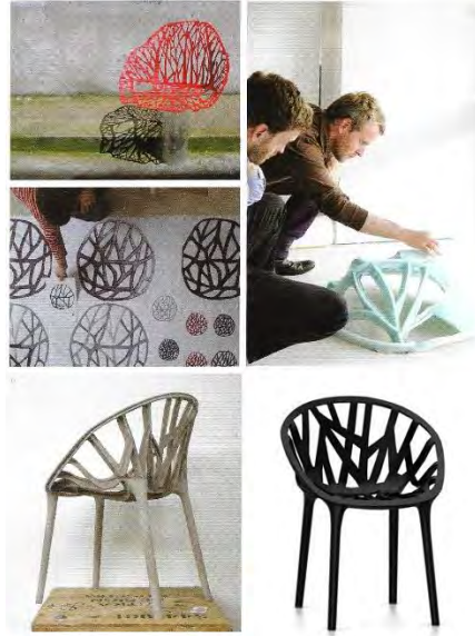
Görsel 5.3. Ronan ve Erwan Bouroullec tasarımı Vegetal Sandalye 'nin tasarım süreci; kağıttan maketleri, strafordan üretilen 1/1 ölçekli prototipi, yüksek yoğunluklu poliüretandan üretilen son prototip ve sandalyenin orijinali (Lawson, 2013, s.119)
