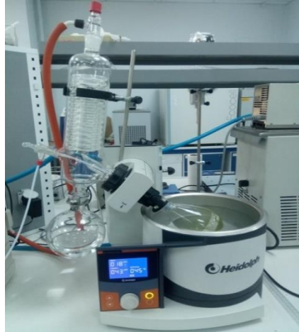
Görsel 3.1. Rotavaporda çözücülerin uçurulması
