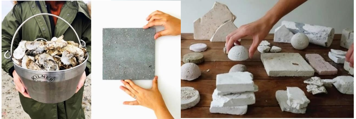
Görsel 1.30. Doğal biyolojik malzemeden geri dönüştürülmüş malzeme üretimi ( https://www.yankodesign.com/2021/09/24/this-sustainable-material-made-from-shell-waste-is-cheaper-eco-friendly-alternative-to-concrete/ ) (Erişim tarihi: 21.02.22)
