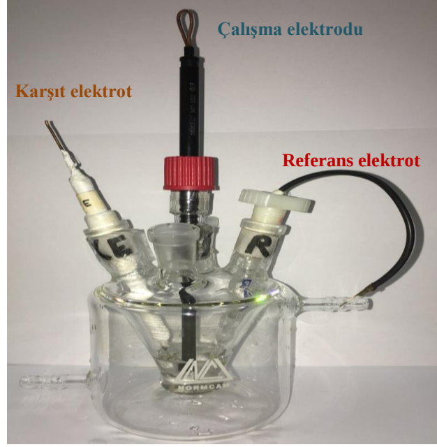
Şekil 2.6. Voltametric ölçümlerde kullanılan hücre ve hücre bileşenleri.
