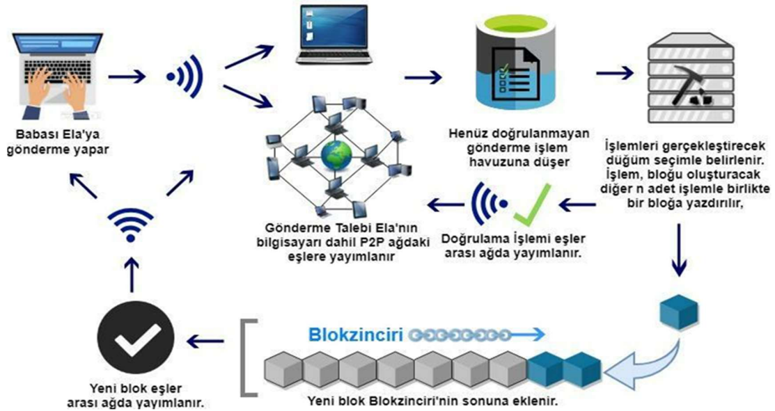
Şekil 3.1 Blokcinciri Sisteminin Çalışma Prensibi
