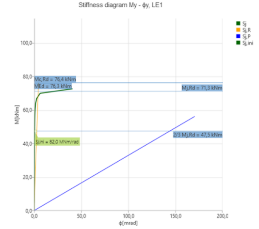
B301 numunesi %2 limit plastik deformasyon için rijitlik diyagramı
