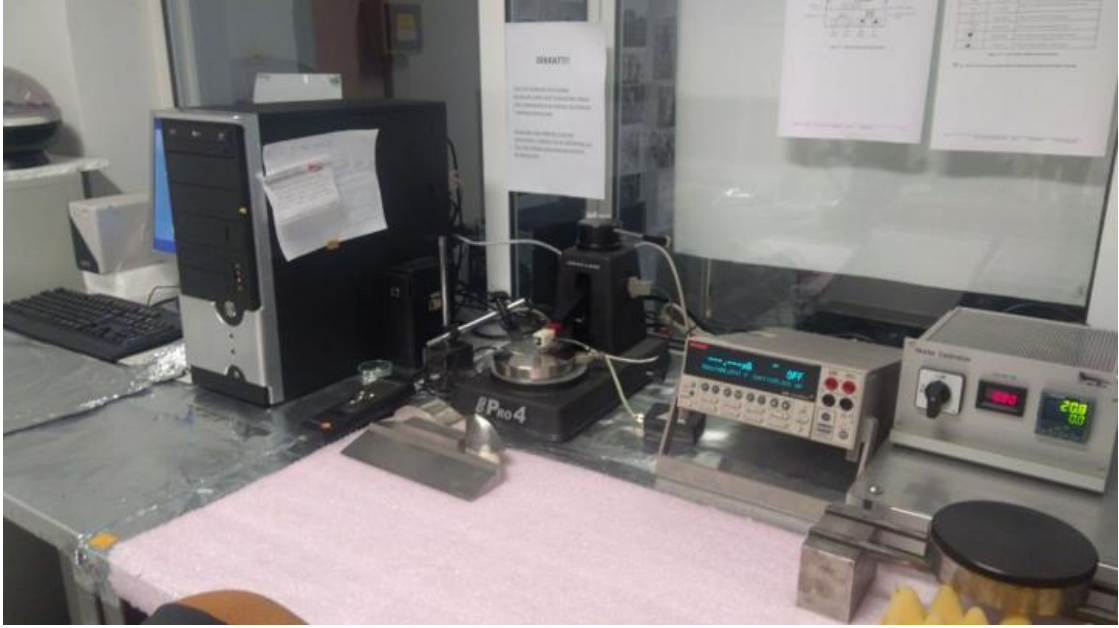
Şekil 5.6 Lucas Labs marka Pro4-4000 model Dört Nokta İğne Tekniği (Anadolu Üniversitesi, İnce Film Laboratuvarı)
