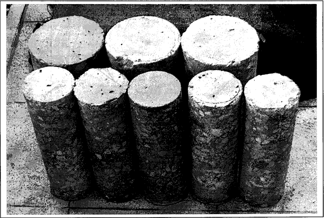
Şekil 6.21. Çıkarılan karot numunelerin görünümü
