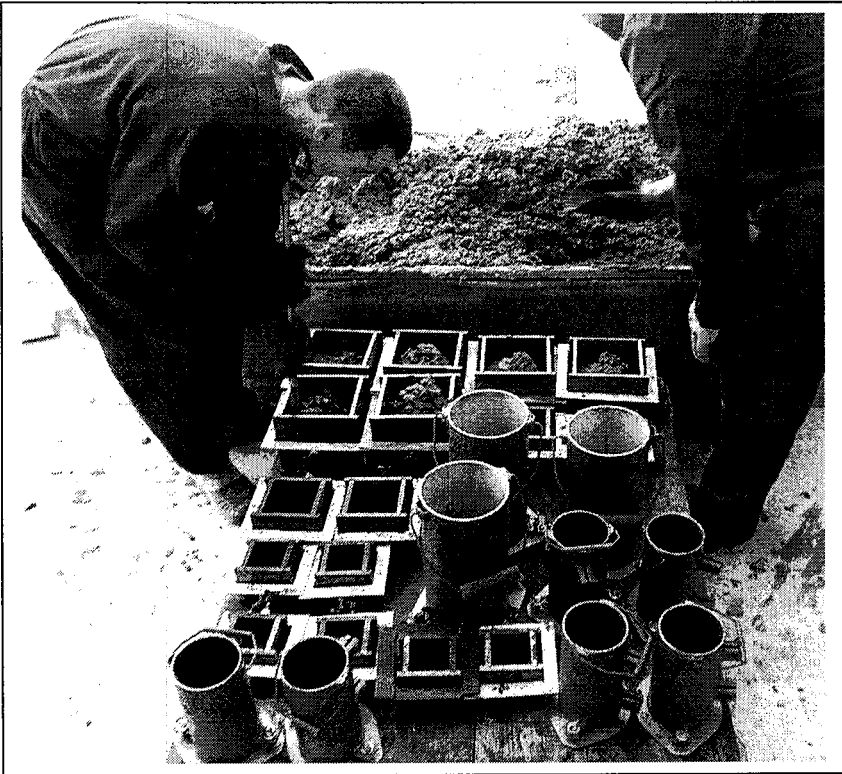
Şekil 6.6. Betonun standart deneylerde kullanılan kalıplara yerleştirilmesi işlemi
