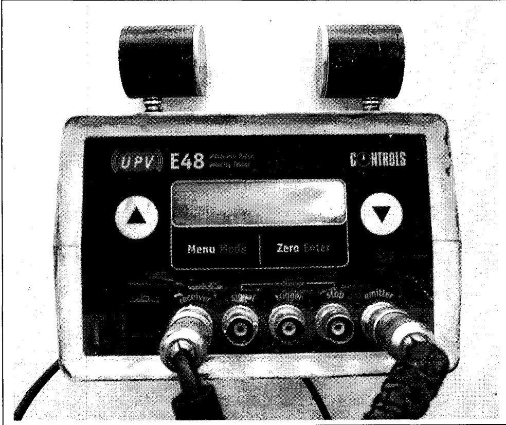
Şekil 6.29. Deneylerde kullanılan sesüstü atım hızı test cihazı
