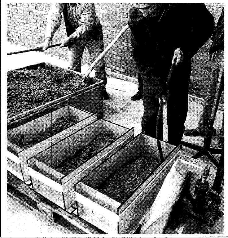
Şekil 6.9. Kiriş kalıplarına yerleştirilen betonun sıkıştırılması işlemi
