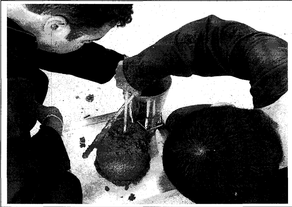
Şekil 6.11. Taze betonda çökme deneyinin uygulaması
