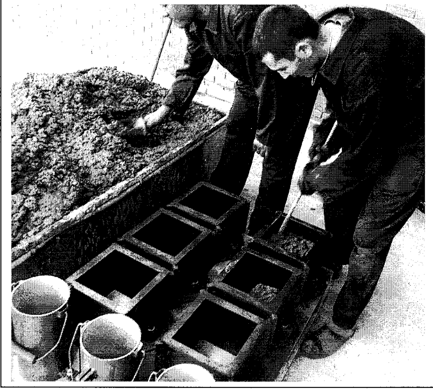
Şekil 6.7. Standart deney kalıplarına yerleştirilen betonun sıkıştırılması işlemi
