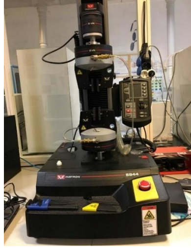
Şekil 3.17. Çekme testi cihazı
