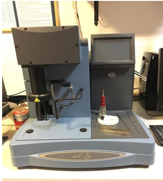
Şekil 3.7. Termal gravimetrik analiz cihazı (TGA)
