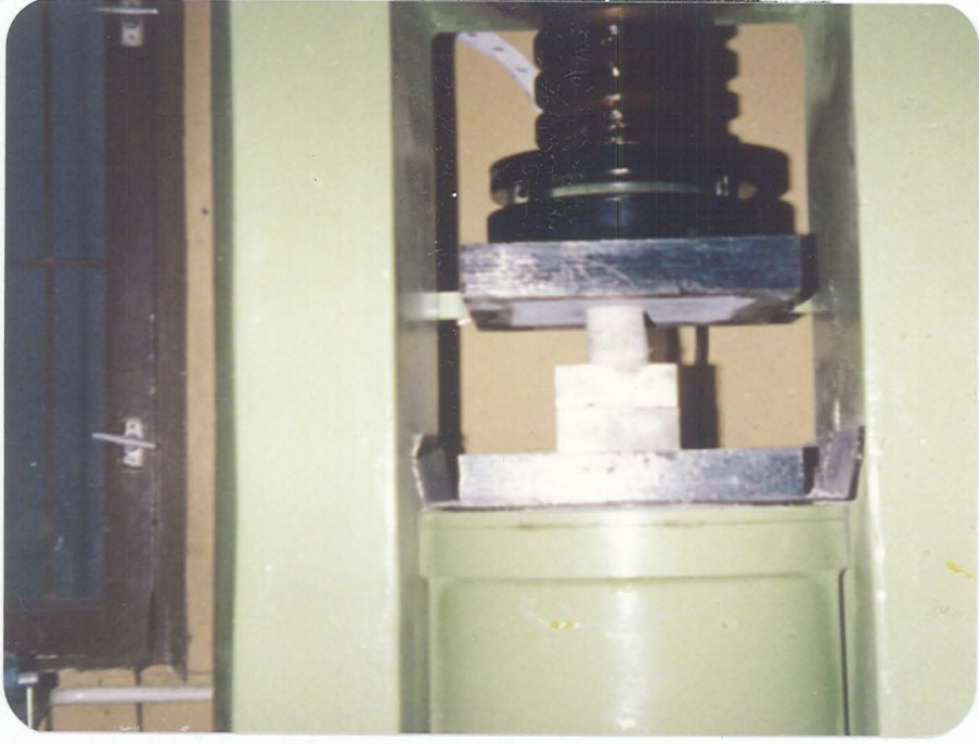
Fotoğraf 7.1. Tek Eksenli Basınc Deneyinin Yapılışı
