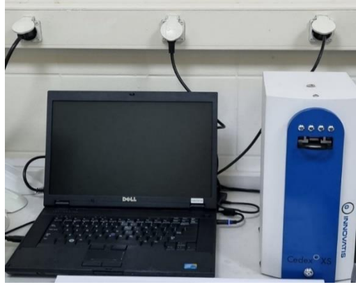
Şekil 3. 1. Hücre sayım cihazı (Cedex, Roche)
