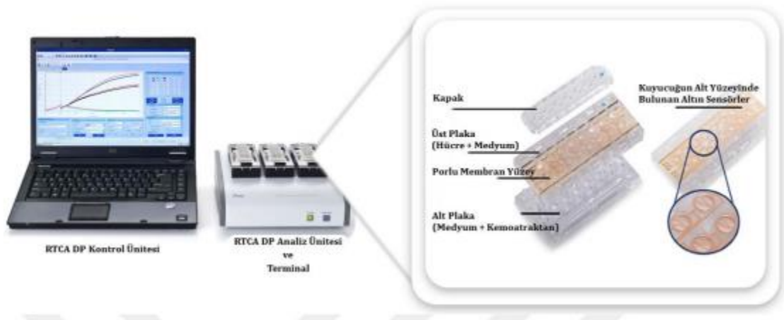
Şekil 3. 6. Gerçek zamanlı hücre analiz sistemi (RTCA) DP sistemi ve CIM-plate (16 kuyucuklu) plakanın parçaları (Varol, 2017)
