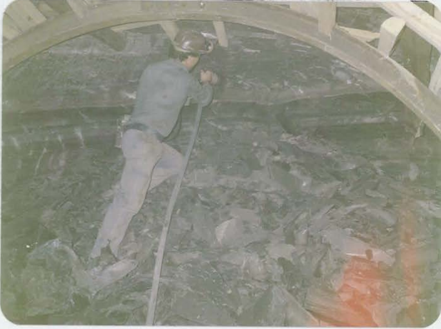
Resim:7.6 Bağ yeri açmak için yapılan tarama çalışması
