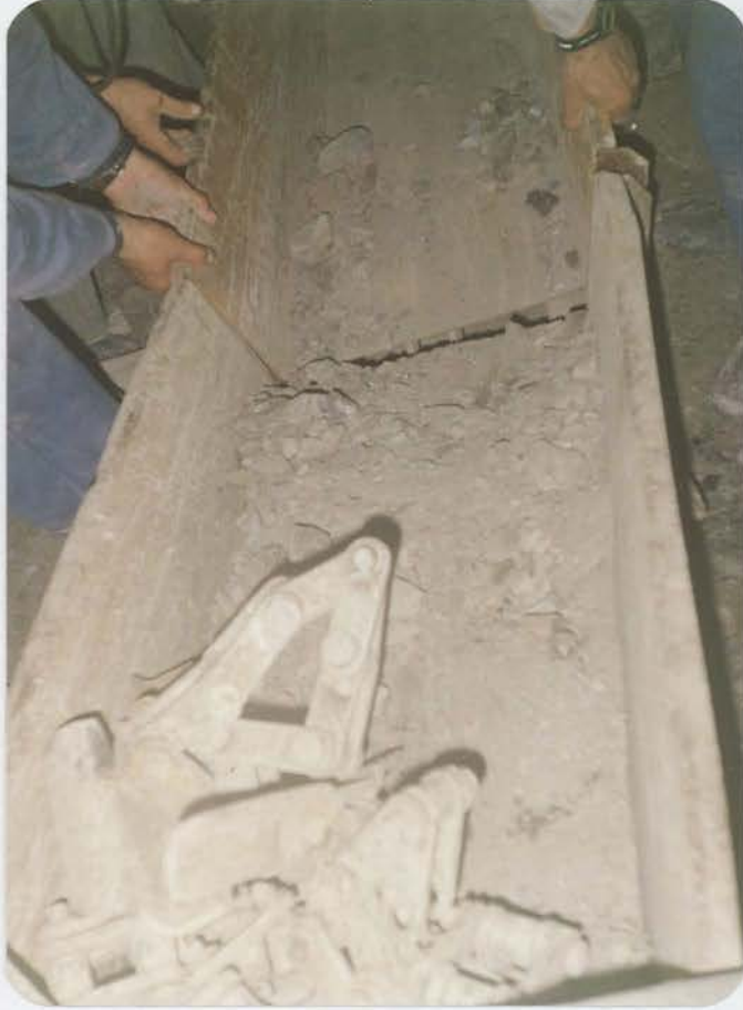
Resim: 7.5 Tek zincirli konveyör oluđu montajı
