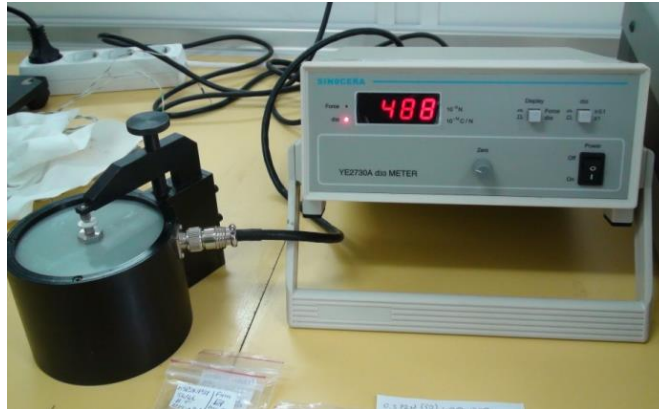
Şekil 6.20. d_{33} ölçüm düzeneği
