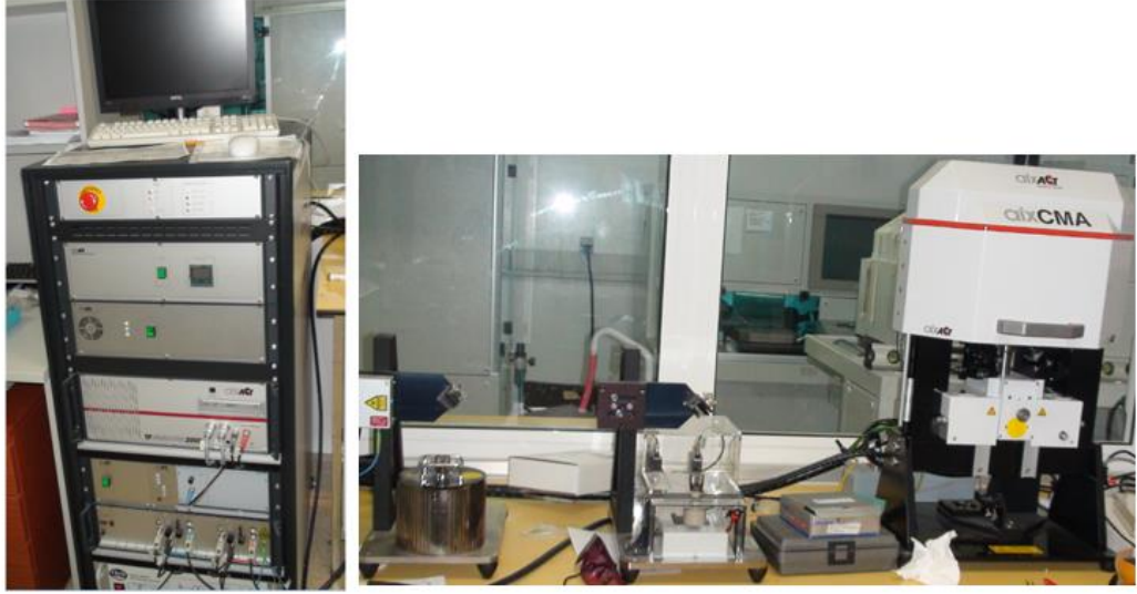
Şekil 6.25. AIXACT Ferroelektrik Ölçüm Düzenegi
