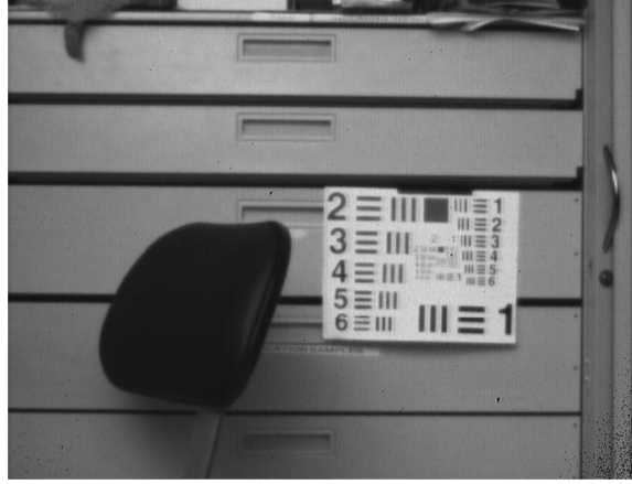
Şekil 1.3. (a) Karanlık akım düzeltilmiş dedektör
