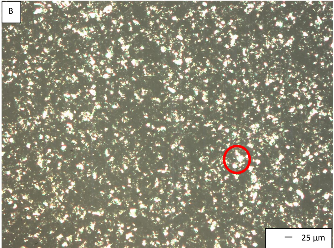
Şekil 7.41. P2 süspansiyonu ile parlatılan 3 nolu numuneye ait (a), (c), (e) parlatma öncesi (b), (d), (f) parlatma sonrası ışık mikroskobu görüntüleri
