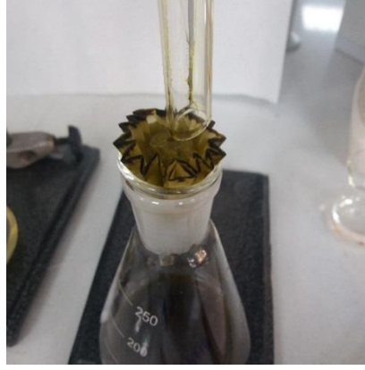
Şekil 3.8. Ekstrelerin Susuz \text{Na}_2\text{SO}_4 'den Geçirildiği Filtrasyon İşlemi
