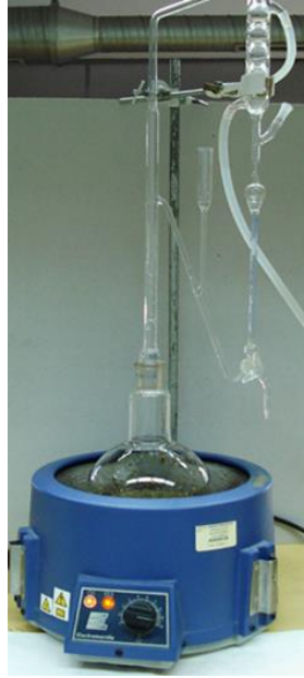
Şekil 3.4. Clevenger Aparatında Hidrodistilasyon İşlemi
