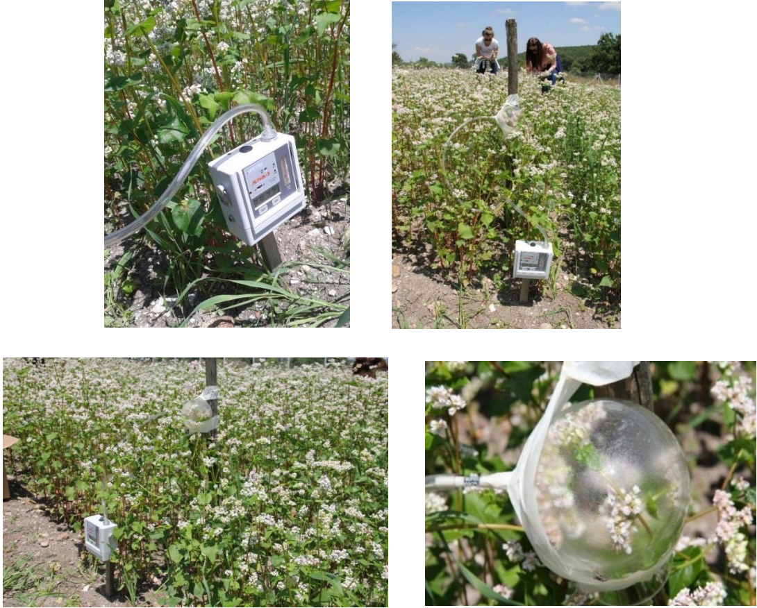
Şekil 3.5. Arazi Şartlarında Gerçekleştirilen HS-SPME İşlemi
