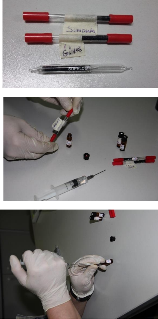
Şekil 3.6. SPME İşlemi Sonucunda Elde Edilen Uçucu Bileşenlerin Adsorban Maddeden Elüe Edilme İşlemi
