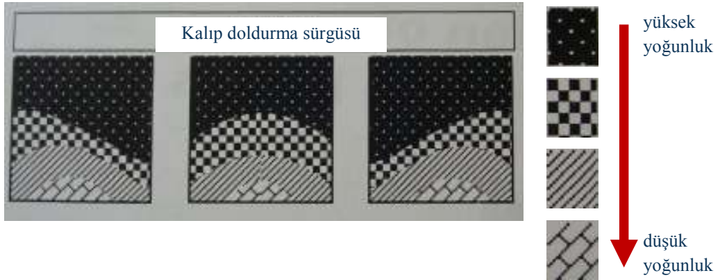
Şekil 2.2. Preslenmiş üründe yoğunluk dağılımı (kesit alanı) (Werr 2002)
