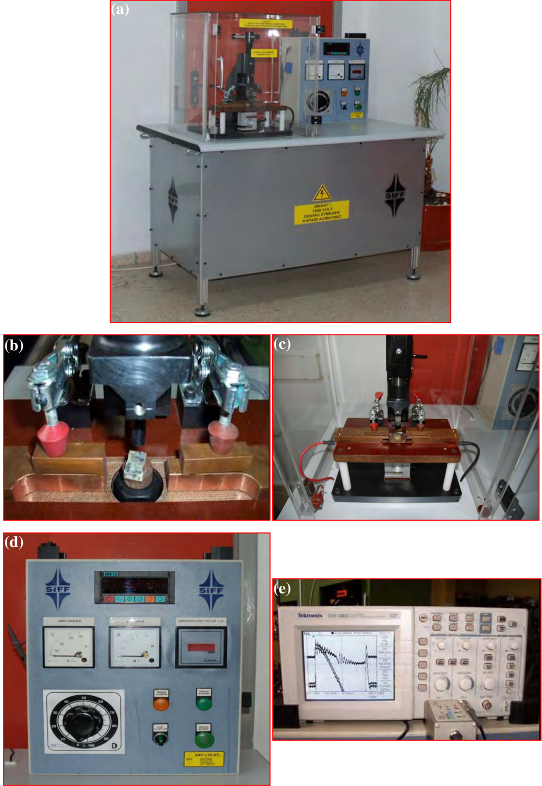
Şekil 4.1. (a) Kapasitör deşarj kaynaklama cihazı (b) Numune haznesi ve sıkıştırma tertibatı (c) Numune haznesi, sıkıştırma ve mekanik yükleme tertibatı (d) Kontrol panosu elemanları (e) Tektronix cihazı
