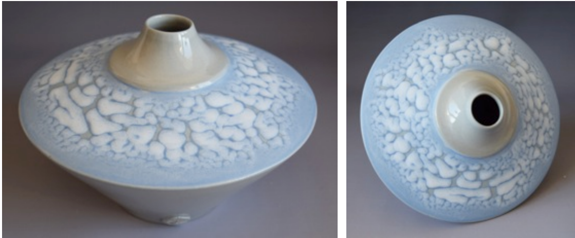
Görsel 4.1. Renkli bünye üzerine 4 MgZS kodlu toplanmalı sır uygulanan form, 24x16x24 cm, (1160 °C)
