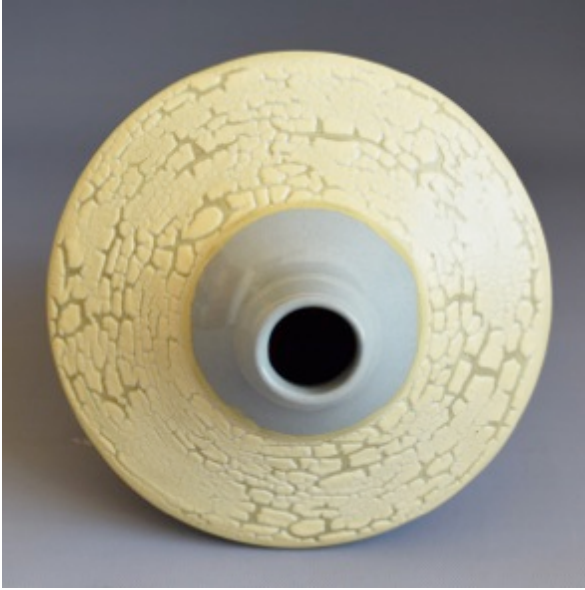
Görsel 4.6. Renkli bünye üzerine 4 MgTS kodlu toplanmalı sır uygulanan form, 14x21x14cm, (1160 °C) Kaynak: Yıldırım, 2019
