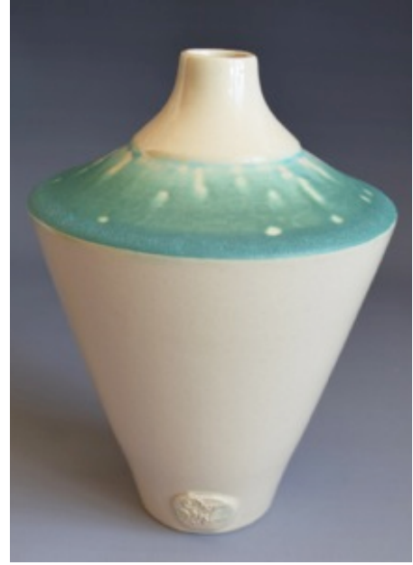
Görsel 4.12. % 3 CuO katkılı 6 MgZS kodlu toplanmalı sır uygulanan form, 14x21x14cm, (1160 °C)
