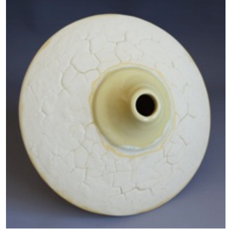
Görsel 4.20. Ticari sarı renkli sır ile 9 MTS kodlu toplanmalı sır uygulanan form, 24x16x24 cm, (1160 °C)
