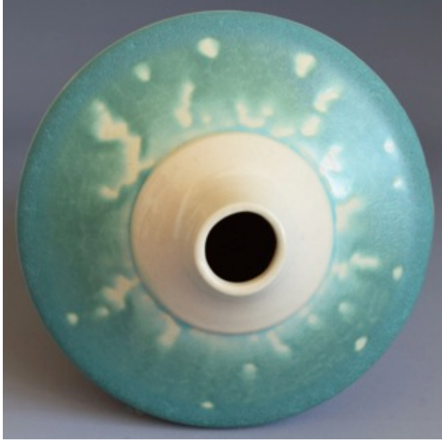
Görsel 4.12. % 3 CuO katkılı 6 MgZS kodlu toplanmalı sır uygulanan form, 14x21x14cm, (1160 °C)
