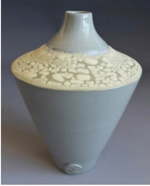
Görsel 4.7. Renkli bünye üzerine 6 MgTS kodlu toplanmalı sır uygulanan form, 14x21x14cm, (1160 °C)
