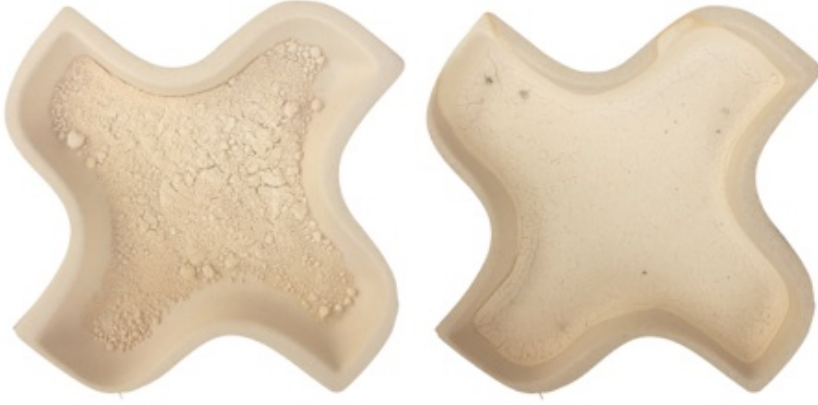
Görsel 3.4 (a) kuru, (b) sulu olarak bisküvi bünyeye uygulanan manyezitin (Kümaş) pişirim sonrası yüzey görünümü (1160 °C).
