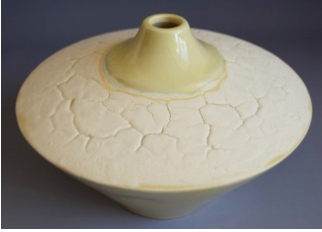
Görsel 4.20. Ticari sarı renkli sır ile 9 MTS kodlu toplanmalı sır uygulanan form, 24x16x24 cm, (1160 °C)
