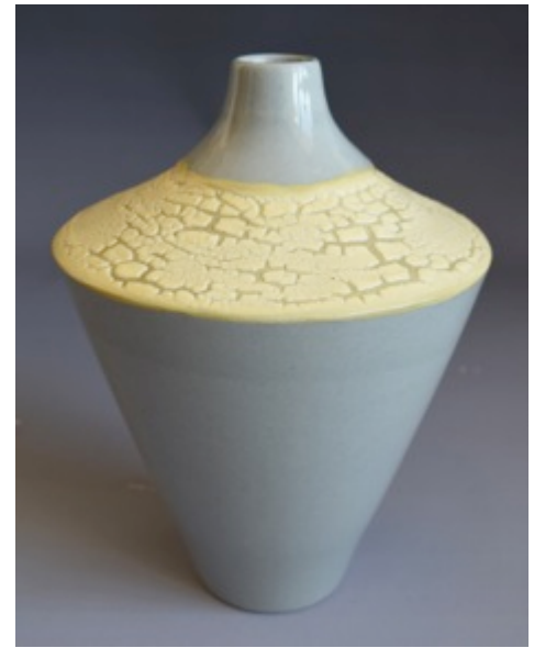
Görsel 4.6. Renkli bünye üzerine 4 MgTS kodlu toplanmalı sır uygulanan form, 14x21x14cm, (1160 °C) Kaynak: Yıldırım, 2019
