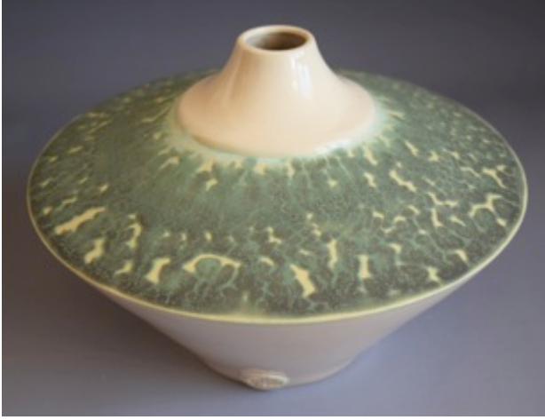
Görsel 4.11. % 3 CuO katkılı 6 MgTS kodlu toplanmalı sır uygulanan form, 24x16x24 cm, (1160 °C)
