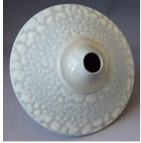
Görsel 4.5. Renkli bünye üzerine 9 MgZS kodlu toplanmalı sır uygulanan form, 24x16x24 cm, (1160 °C) Kaynak: Yıldırım, 2019
