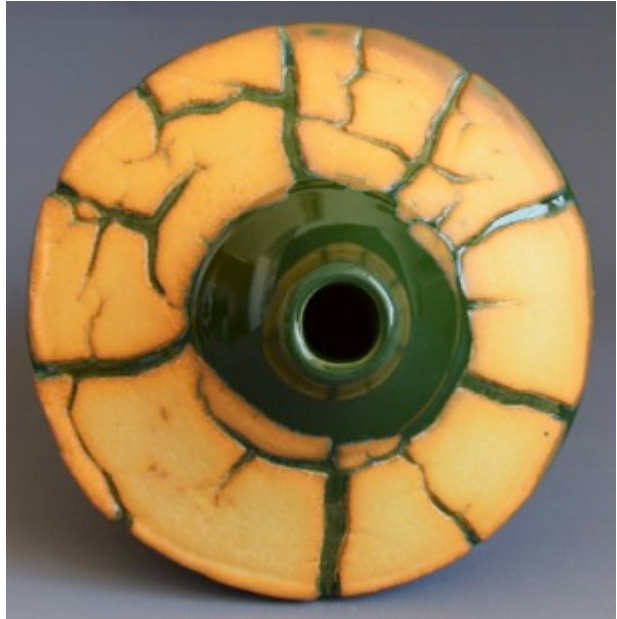
Görsel 4.26. Ticari yeşil renkli sır ile 4 MTS kodlu toplanmalı sır uygulanan form, 14x21x14cm, (1160 °C)
