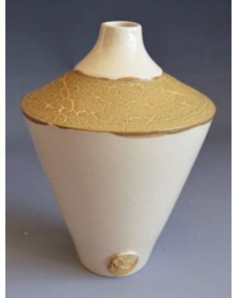
Görsel 4.14. % 3 Cr_2O_3 katkılı 4 ZTS kodlu toplanmalı sır uygulanan form, 14x21x14cm, (1160 °C)
