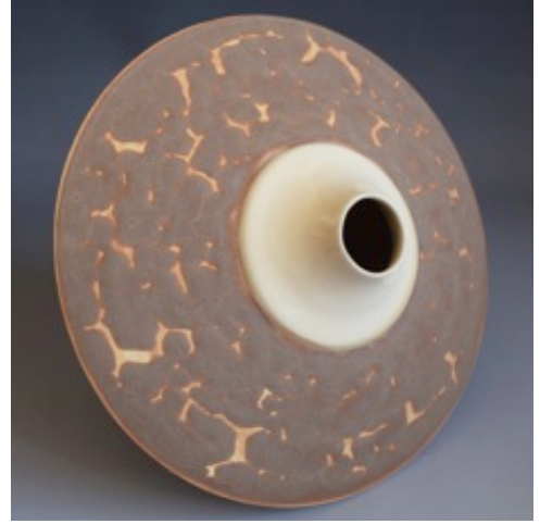
Görsel 4.13. % 3 Cr_2O_3 katkılı 4 MgZS kodlu toplanmalı sır uygulanan form, 24x16x24 cm, (1160 °C)
