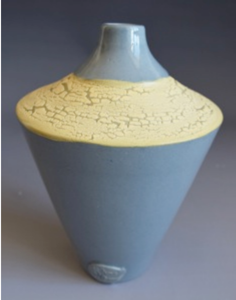
Görsel 4.8. Renkli bünye üzerine 7 MgTS kodlu toplanmalı sır uygulanan form, 14x21x14cm, (1160 °C)
