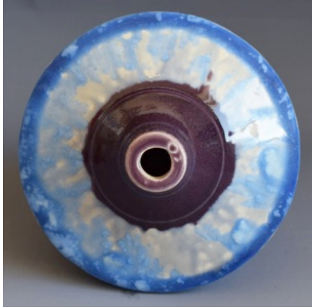
Görsel 4.24. Ticari mor renkli sır ile 7 MZS kodlu toplanmalı sır uygulanan form, 14x21x14cm, (1160 °C)
