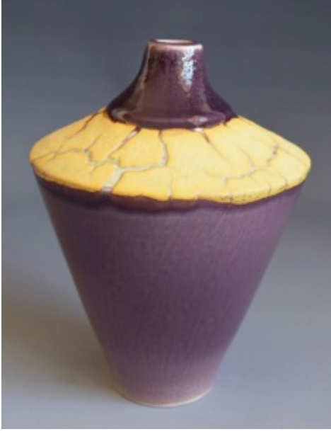
Görsel 4.23. Ticari mor renkli sır ile 4 MTS kodlu toplanmalı sır uygulanan form, 14x21x14cm, (1160 °C)
