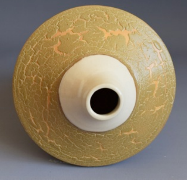
Görsel 4.14. % 3 Cr_2O_3 katkılı 4 ZTS kodlu toplanmalı sır uygulanan form, 14x21x14cm, (1160 °C)
