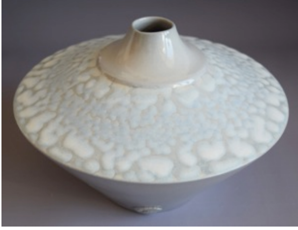
Görsel 4.5. Renkli bünye üzerine 9 MgZS kodlu toplanmalı sır uygulanan form, 24x16x24 cm, (1160 °C) Kaynak: Yıldırım, 2019
