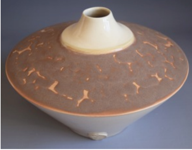
Görsel 4.13. % 3 Cr_2O_3 katkılı 4 MgZS kodlu toplanmalı sır uygulanan form, 24x16x24 cm, (1160 °C)
