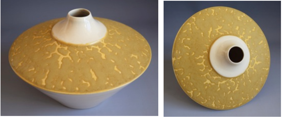
Görsel 4.16. % 3 Fe_2O_3 katkılı 4 MgTS kodlu toplanmalı sır uygulanan form, 24x16x24 cm, (1160 °C)
