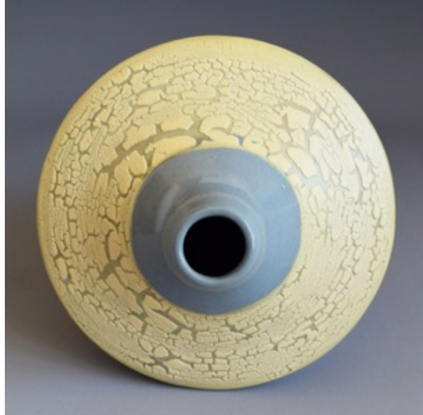
Görsel 4.8. Renkli bünye üzerine 7 MgTS kodlu toplanmalı sır uygulanan form, 14x21x14cm, (1160 °C)
