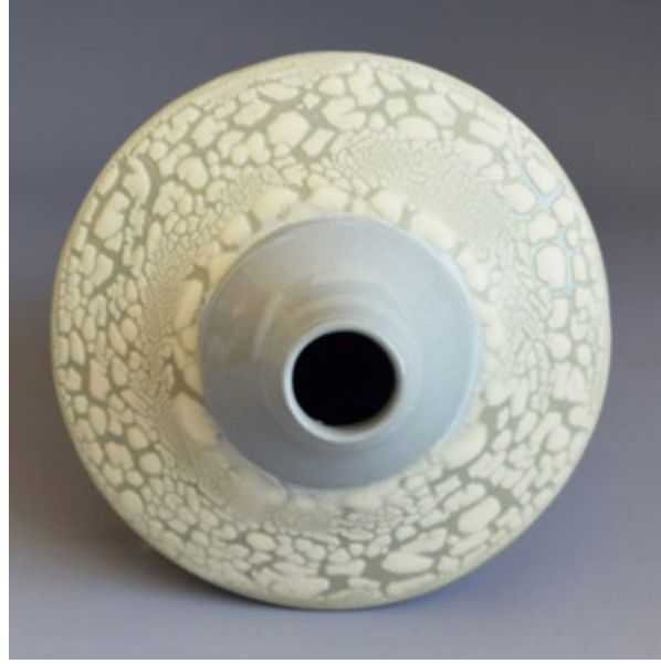
Görsel 4.7. Renkli bünye üzerine 6 MgTS kodlu toplanmalı sır uygulanan form, 14x21x14cm, (1160 °C)
