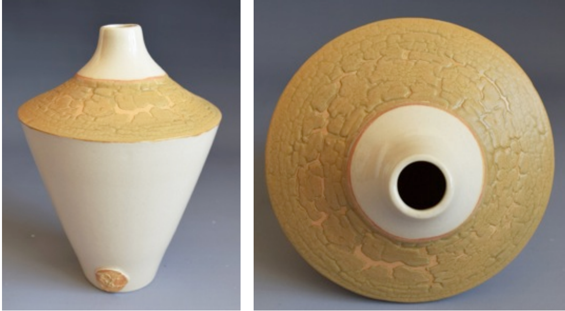
Görsel 4.18. % 3 Fe_2O_3 katkılı 4 ZTS kodlu toplanmalı sır uygulanan form, 14x21x14cm, (1160 °C)
