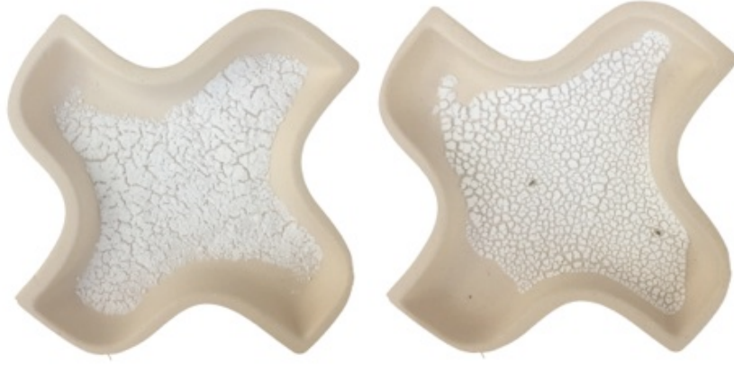
Görsel 3.3. (a) kuru, (b) sulu olarak bisküvi bünyeye uygulanan magnezyum hidroksi karbonatın pişirim sonrası yüzey görünümü (1160 °C).
