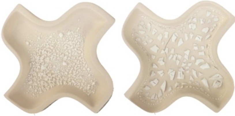
Görsel 3.5. (a) kuru, (b) sulu olarak bisküvi bünyeye uygulanan magnezyum bi karbonatın pişirim sonrası yüzey görünümü (1160 °C).
