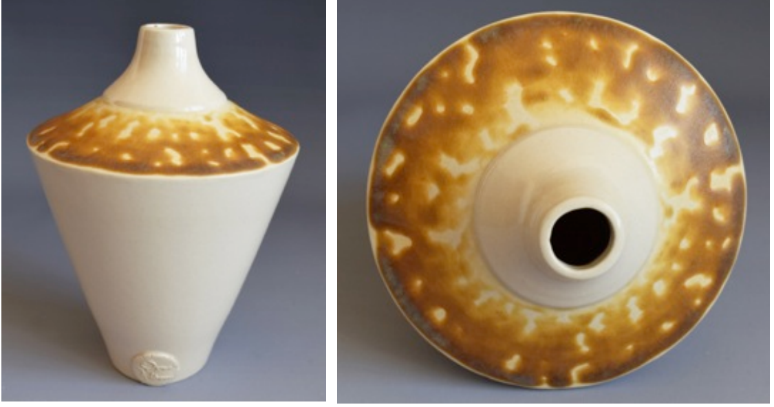
Görsel 4.17. % 3 Fe_2O_3 katkılı 6 MgZS kodlu toplanmalı sır uygulanan form, 14x21x14cm, (1160 °C)
