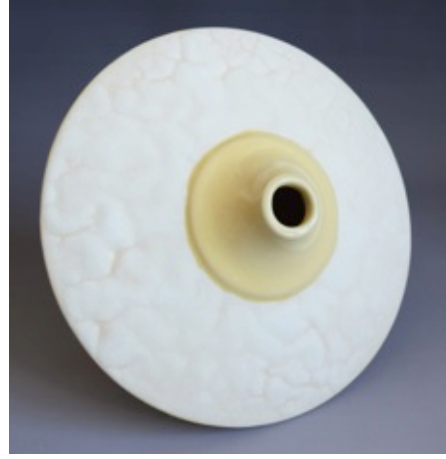
Görsel 4.21. Ticari sarı renkli sır ile 7 MZS kodlu toplanmalı sır uygulanan form, 24x16x24 cm, (1160 °C)
