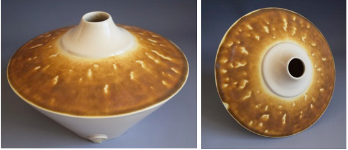
Görsel 4.15. % 3 Fe_2O_3 katkılı 4 MgZS kodlu toplanmalı sır uygulanan form, 24x16x24 cm, (1160 °C)
