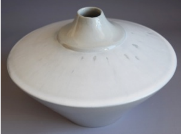
Görsel 4.2. Renkli bünye üzerine 6 MgZS kodlu toplanmalı sır uygulanan form, 24x16x24 cm, (1160 °C)
