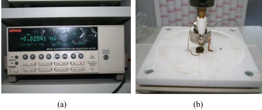
Şekil 6.4. a) Keithley marka yüksek direnç ölçer b) Numunelerin yerleştirilmesi.
