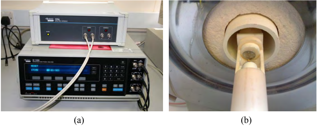
Şekil 6.5. a) Solartron 1260 empedans analizörü b) Platinyum elektrotlar
