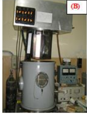
Şekil 4.4. (a) Pres yöntemi ile hazırlanmış seramik hedef malzemeler ve (b) magnetron sıçratma yönteminde kullanılacak ekipmanlar bütünü
