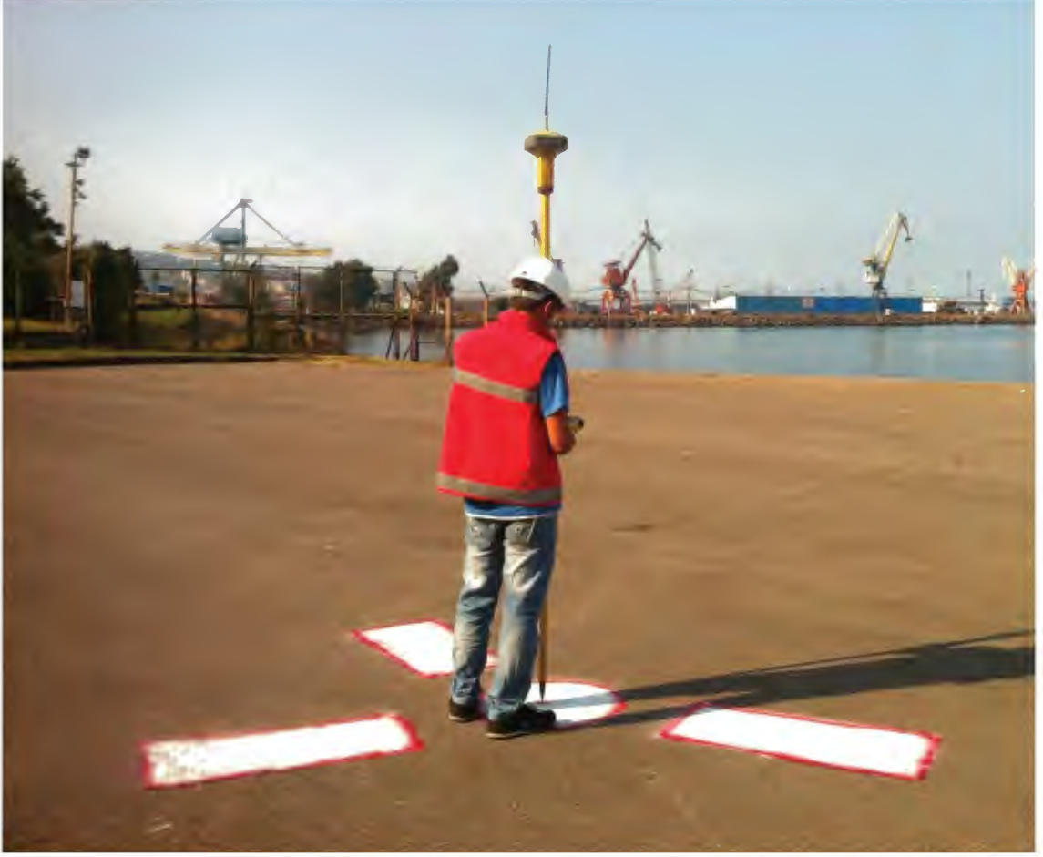
Görsel 2.1. YKN tesisi ve ölçümü
