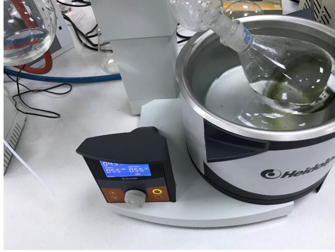
Şekil 3.3. Çözücülerin düşük basınç altında rotavaporda uzaklaştırılması
