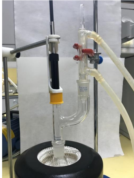
Şekil 3.4. Ekstraksiyon için kullanılan MSD-SPME düzeneği
