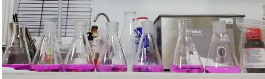
Görsel 4.11. Laktik asit tayini deneyi titrasyon sonucu renk oluşumu
