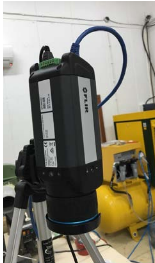
Görsel 4.17. FLIR A655sc Termal Kamera
