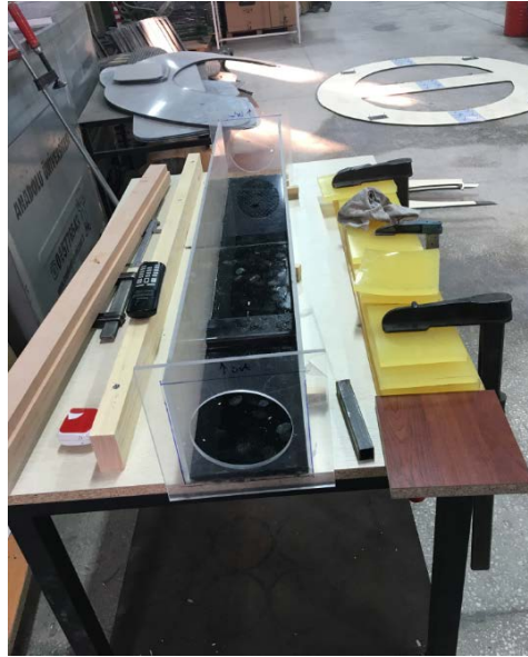
Görsel 4.10. Optik Hava Tünel Montajı
