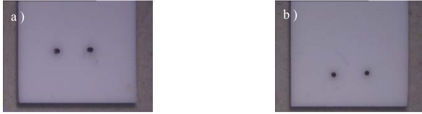
Şekil 4.26. a) 500 mikron b) 300 mikron çapında lazer ile alümina altlığın işlenmesi sonucu oluşturulan deliklerin stereo mikroskop görüntüleri
