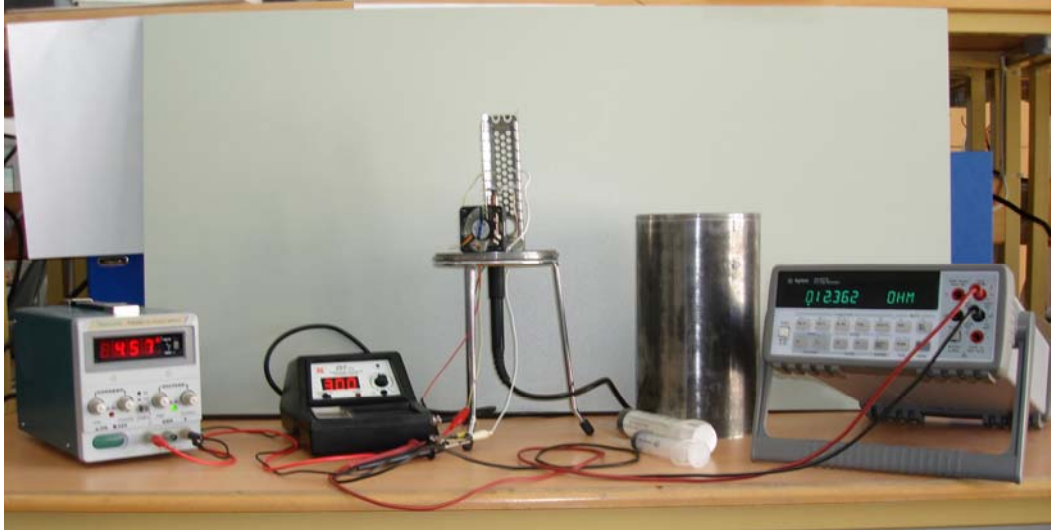
Şekil 6.1. Gaz test kabininin yanyüzeyleri ve üst kapağı yok iken sensörün konulduğu ısıtılabilen yüzeyi (alümina altlık) gösteren fotoğraf
