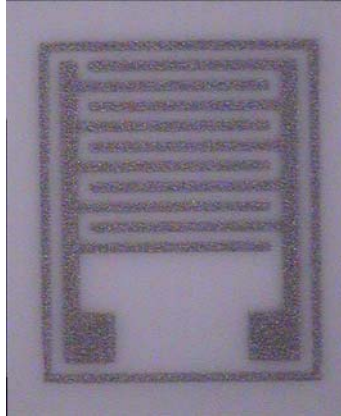
Şekil 4.18. Büyük altlık üzerine açısız olarak gerilmiş 120 meshlik elek ile elde edilen 6mmx 4mm baskının EPD kaplama için hazırlanmış ısıt işlem sonrası görüntüsü
