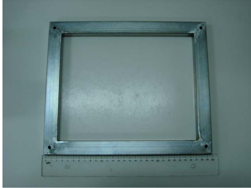
Şekil 4.12. Litografi, ipek baskı için hazırlanan çerçevenin görüntüsü
