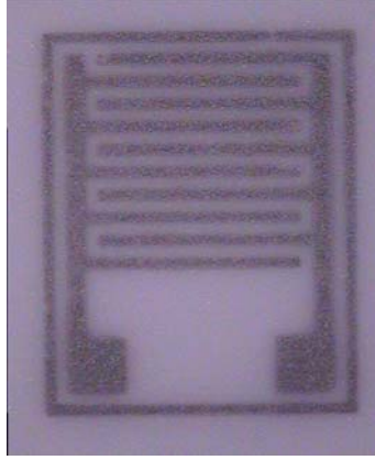
Şekil 4.20. Küçük altlık üzerine açılı olarak gerilmiş 120 meshlik elek ile elde edilen 6 mmx 4mm baskının EPD kaplama için hazırlanmış ısıtılmış işlem sonrası görüntüsü
