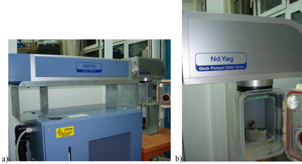
Şekil 4.25. Alümina altlık üzerine delik açmada kullanılan lazer cihazı
