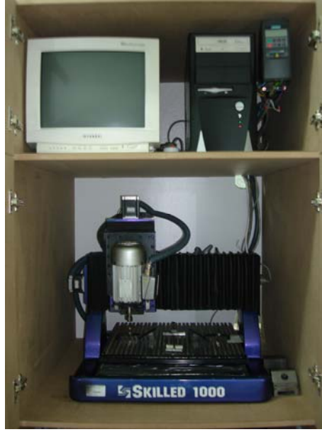
Şekil 4.22. İpek baskı ünitesi için yatak hazırlamada kullanılan CNC cihazı
