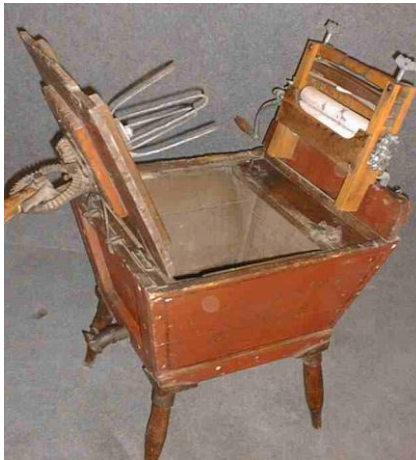
Şekil 2.12. 1890 yılındaki çamaşır makinesi modeli (üreticisi bilinmemektedir) [9]
