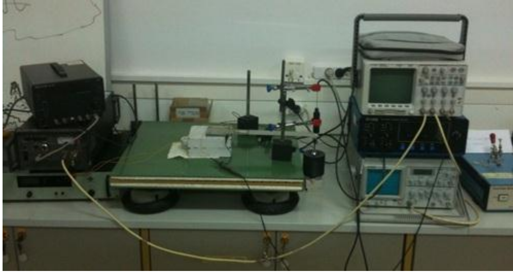
Şekil 4.7. Bir boyutta yapılan titreşim test düzeneği
