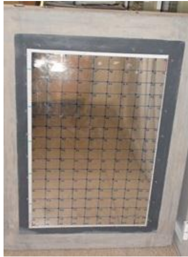
Şekil 4.18. Sac levhanın beton bloğa sabitlenmiş pozisyonu
