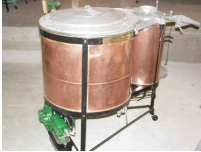
Şekil 2.19. Syracuse Washing Machine Şirketinin 1918 yılı yapımı çamaşır makinesi [9]
