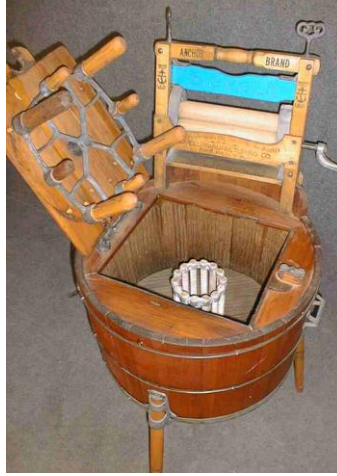
Şekil 2.11. 1890 yılına ait bir çamaşır makinesi modeli (üreticisi bilinmemektedir) ABD [9]
