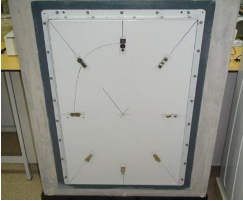
Şekil 4.23. Titreşen levhaya yerleştirilmiş piezoseramik elemanlar
