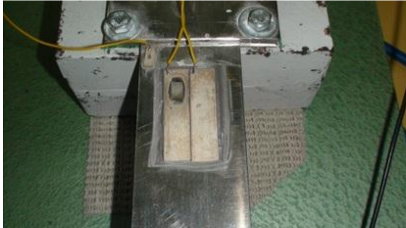
Şekil 4.6. Kiriş üzerine yapıştırılmış piezoelemanlar
