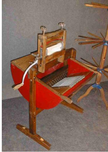
Şekil 2.8. D. Brainard'ın tasarladığı çamaşır makinesi [9]
