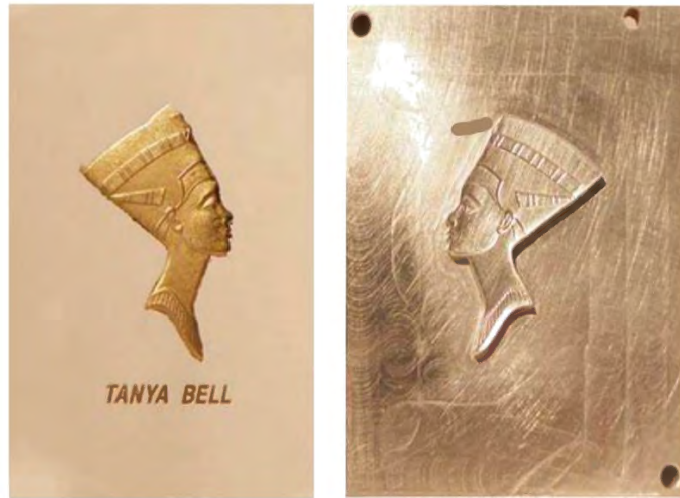
Görsel 3.20. CNC ile oluşturulmuş Gofre baskı kalıbı ve baskısı.
