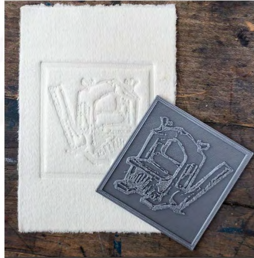
Görsel 3.22. Lazer Kesim Kalıp ve Baskı Örneği.
