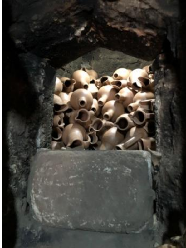
Görsel 2.14. Kara Fırın'ın Kayacak Kapısının Kapatılması
