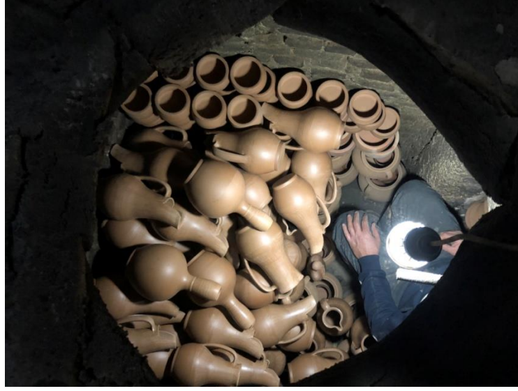
Görsel 2.13. Ürünlerin Kara Fırına Yerleştirilme Aşaması Ağız'dan Görüntü
