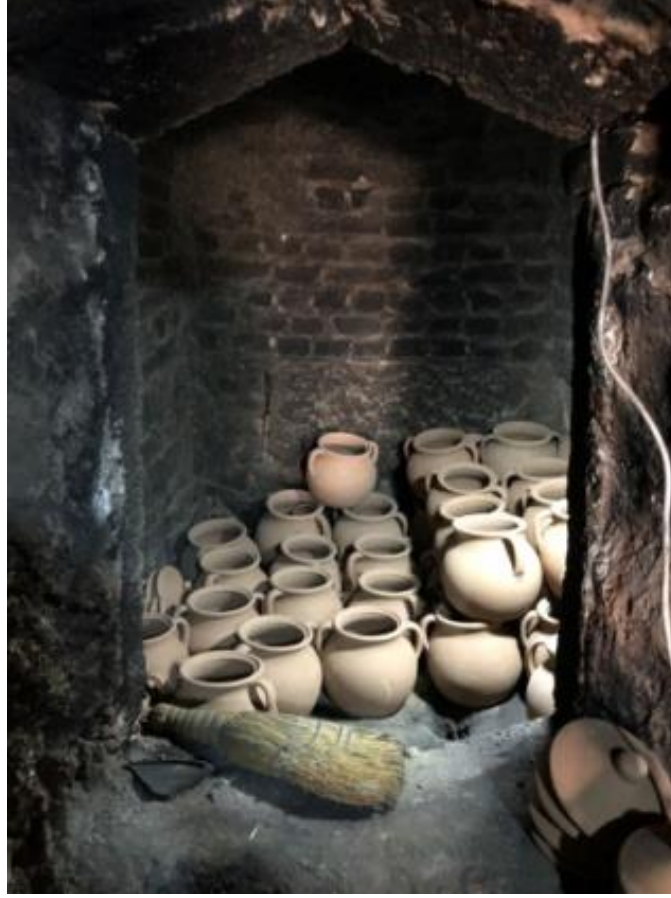
Görsel 2.12. Ürünlerin Kara Fırına Yerleştirilme Aşaması
