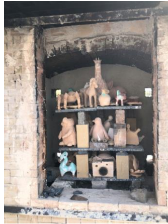
Görsel 2.35. Tuz Fırını Yerleştirme Aşaması
