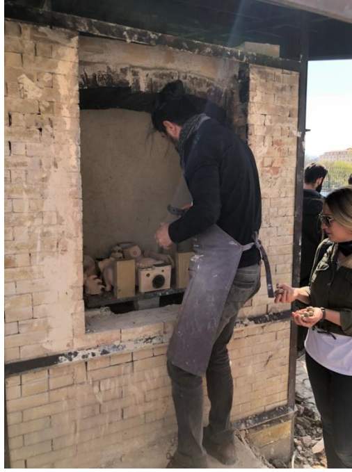
Görsel 2.34. Tuz Fırını'na Seramiklerin Yerleştirilme Aşaması
