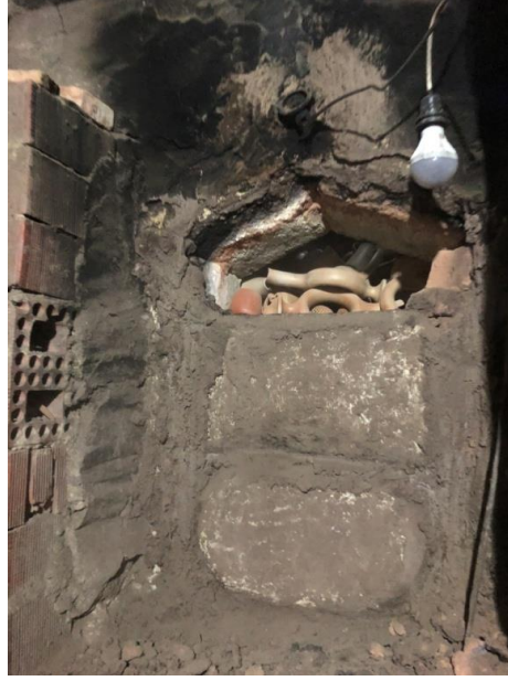
Görsel 2.19. Kara Fırın Kayacak Kapısı'nın Açılma Aşaması
