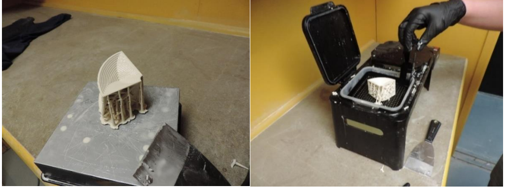
Görsel 3.27. SLA yazıcıyla biçimlendirme sonrasında formun makineden ayrılması ve alkole daldırılması, Tethon 3D firması Kaynak: Emre CAN fotoğraf arşivi
