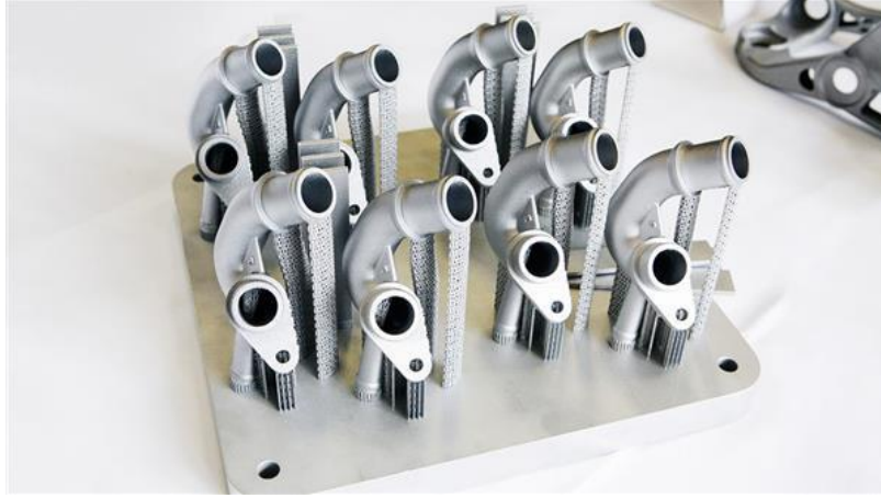
Görsel 2.13. Seçici lazer ergitme yöntemi ile AUDI firması tarafından üretilmiş metal motor parçası (SLM)
