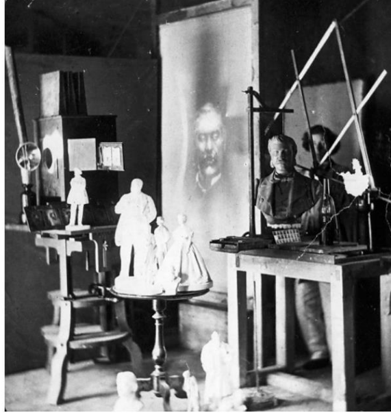
Görsel 2.1. Willeme'in foto- heykel photosculpture ile katı model üretim süreci, 1863 Kaynak: Beaman, J.J, (2001)
