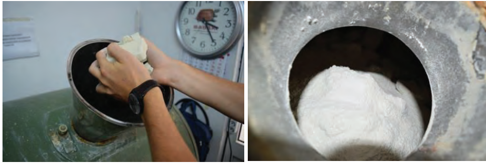
Görsel 3.16. Bilyalı değirmene kurutulmuş şamotlu çamur, bentonit ve \text{TiO}_2 eklenmesi
