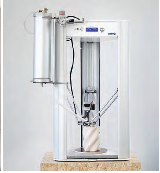
Görsel 2.12. Motor sıkıştırmasıyla çamur yazdıran LDM tipi yazıcı (1),
