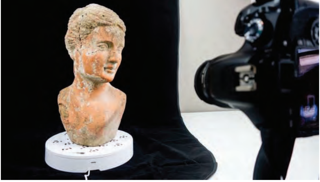
Görsel 1.22. Fotogrametri tekniği tarama e-model oluşturma aşamaları-1
