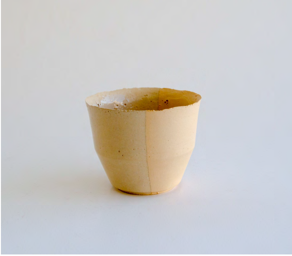
Görsel.5.8. Titanyum oksit katkılı döküm çamuru ile hazırlanan yarısı şeffaf sırlı kase formu.
