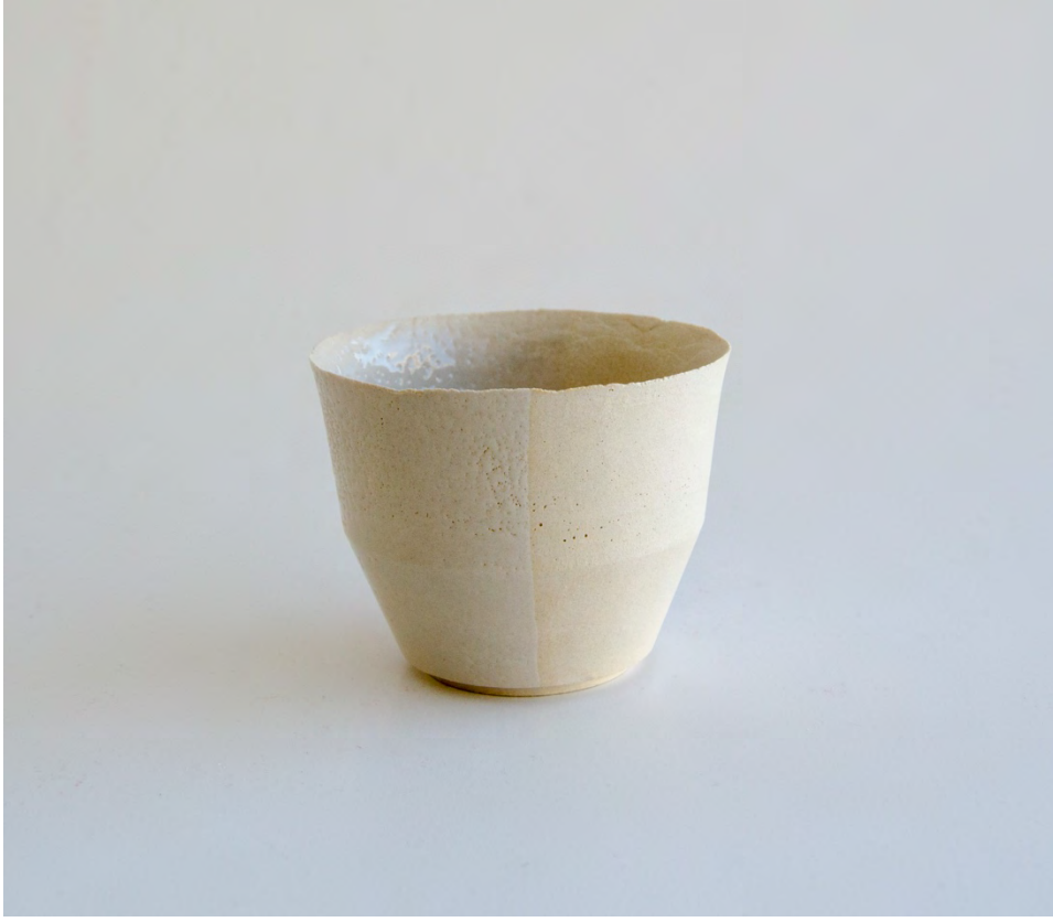
Görsel.5.6. Kalay oksit katkılı döküm çamuru ile hazırlanan yarı şeffaf sırlı kase formu.
