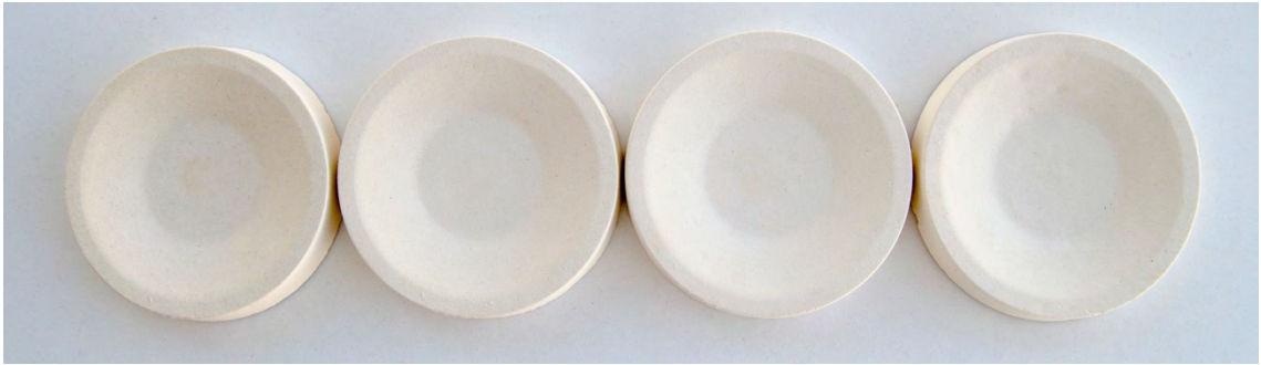
Görsel 5.1. Baryum oksit katkılı döküm çamuru ile hazırlanan deneme plakalarının pişirim sonrası görünümleri.
