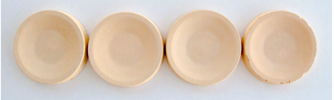
Görsel 5.7. Titanyum oksit katkılı döküm çamuru ile hazırlanan deneme plakalarının pişirim sonrası görünümleri.
