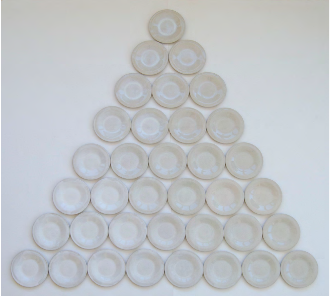
Görsel 5.20. Şeffaf seramik sırına Kalay oksit, Kalsiyum oksit ve Baryum oksit ilave edilerek 1200 °C’de pişirilmiş deney plakaları.
