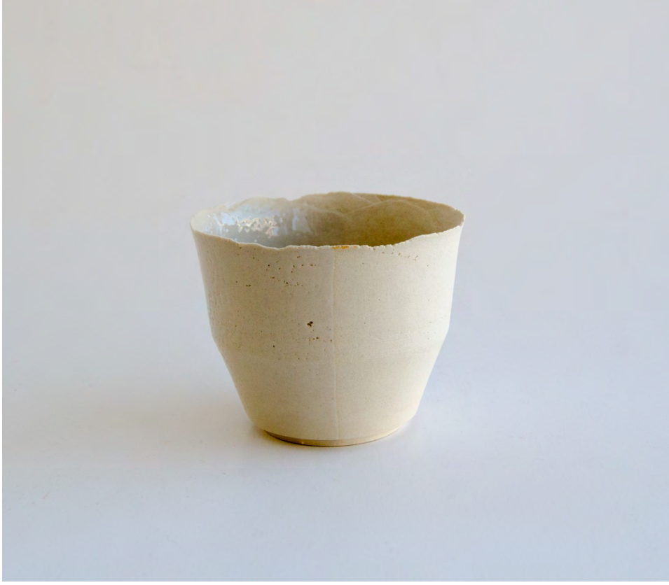
Görsel.5.10. Zirkon oksit katkılı döküm çamuru ile hazırlanan yarısayıffaf sırli kase formu.
