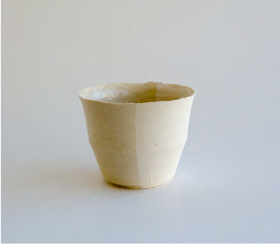
Görsel.5.2. Baryum oksit katkılı döküm çamuru ile hazırlanan yarı şeffaf sırlı kase formu.
