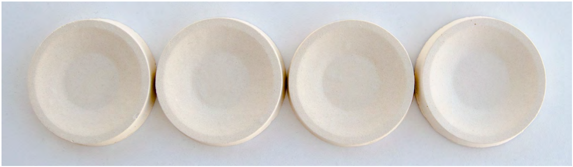
Görsel 5.5. Kalay oksit katkılı döküm çamuru ile hazırlanan deneme plakalarının pişirim sonrası görünüşleri.
