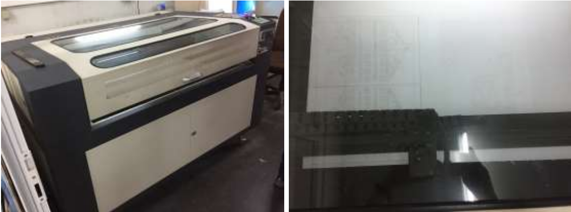
Görsel 5. 22 Areyastis Anıtı yüzey yapısından yararlanılarak oluşturulan desenin CNC tezgahında baskı şablonu hazırlama çalışmaları
