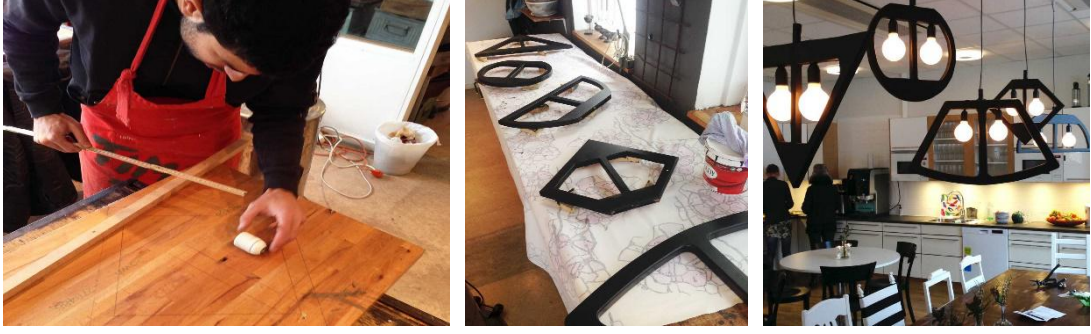
Görsel 3.6.8. Atık malzemelerden tasarlanmış aydınlatma elemanı yapım süreci , recreative Design , Kaynak: http://recreatedesigncompany.com/portfolios/2d-reclaimed-wood-lamps/ , 2018
