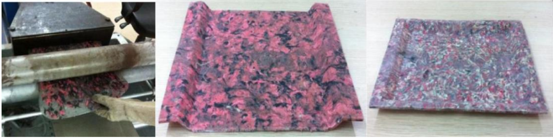
Görsel 2.6.1.3. Tekstil atık takviyeli kompozit çay tepsisi yapım süreci ve sonuç ürün, Kaynak: 34.Yalçın , Sadıkoğlu , Sezgin , Berkalp, 2012
