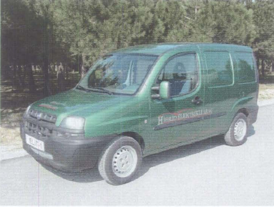
Şekil 6.2: Elit-1 Projesi Kapsamında Hibrid Araca Dönüştürülen Doblo
