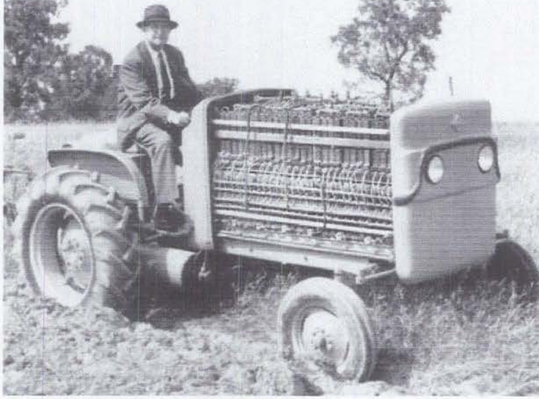
Şekil 5.2.3: Dr. Harry Karl Ihring Yakıt Pili ile Çalışan Traktörü Sürerken, 1959 Kaynak: Stone ve Morrison, 2002
