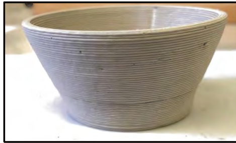
Şekil 8.35. %75 katı oranı ve kütlece %0,07 \text{CaCl}_2 tuzu içeren V9-2 reçetesinin 60^\circ konik şekilde WASP 2040 modelli 3B yazıcıda yazımı sonrası pişmiş görünümü (taban çapı: 4 cm)
