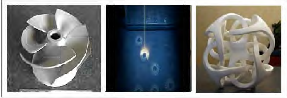
Şekil 5.1. Seçmeli Lazer Sinterleme (Selective Laser Sintering -SLS) yöntemi uygulaması ve elde edilen ürünler [22]
