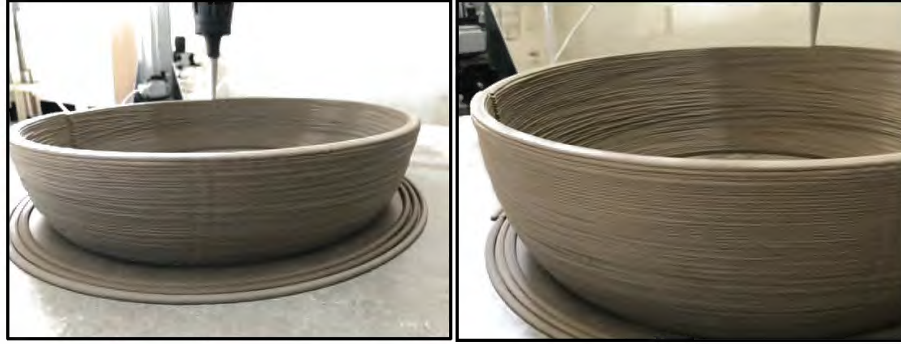
Şekil 8.39. %79 katı oranı ve kütlece %0,04 \text{CaCl}_2 tuzu içeren ince kesit reçetesinin oval şekilde WASP 3MT modelli 3B yazıcıda yazımı sırasındaki görünümü
