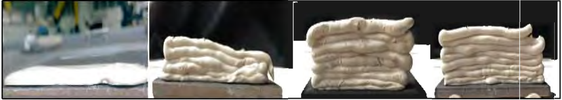
Şekil 8.24. VTİ 283 reçetesi çamurlarının sırasıyla tuz ilavesiz, %0,07 CaCl_2 , %0,09 CaCl_2 ve %0,11 CaCl_2 ilaveli yığılma görüntüleri
