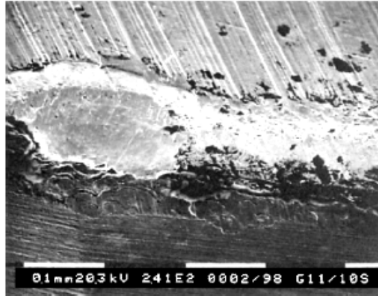
řekil 6.2 PVD yöntemiyle kaplanmış malzemedeki delaminasyon ve sürtünme izleri. 100m/dk hız ve 0,15mm/diř besleme hızıyla 10sn. iřleme zamanı sonrasında oluřan aşınma izleri yapıřan malzemeler [34]
