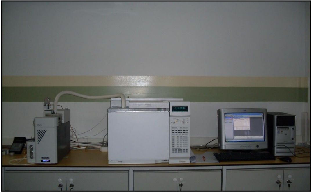
Şekil 4.21. Tenax TA tüplerinde tutulan UOB analizlerinin gerçekleştirildiği GC-TD-FID sistemi
