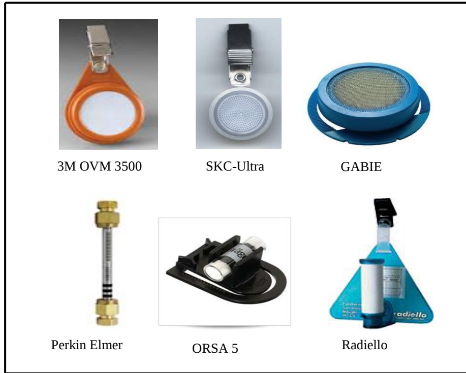
Şekil 2.6. Günümüzde UOB örnekleme çalışmalarında kullanılan farklı pasif örnekleyici türleri
