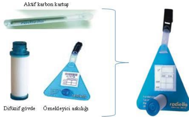
Şekil 4.13. Radiello pasif örnekleyci kısımları ve örnekleme esnasındaki konumu
