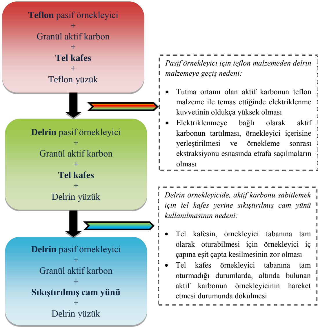
Şekil 4.4. Tez çalışması süresince oluşturulan pasif örnekleyici modifikasyonları
