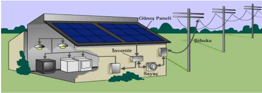
Şekil 3.3. Şebekeye bağlı sistem tasarımı [31]
