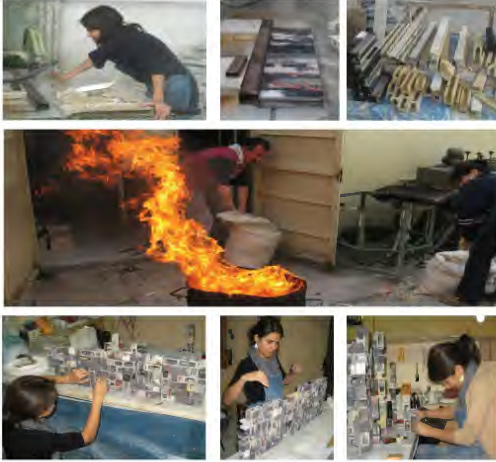
Görsel 241.,Görsel 242., Görsel 243. Kapanmak, Kırılmak, Kararmak ve Kopmak için atık refrakterlerin küp biçiminde kesim işlemi
