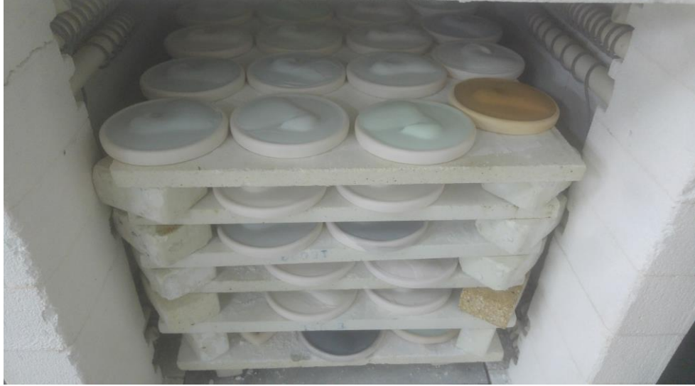
Görsel 3.3. Hazırlanan Sır Deneme Plakaları Fırına Doldurulmuştur (Koç, 2018)
