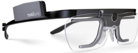
Görsel 3.11. Mobil/head-mounted göz takip cihazı örneği( http-16 )
