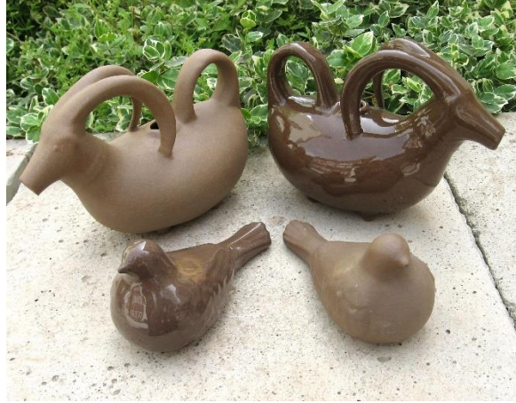
Görsel 1.2. Pişmiş kiremit atığı içeren döküm çamurlarıyla üretilmiş sırlı ve sırsız stoneware formlar
