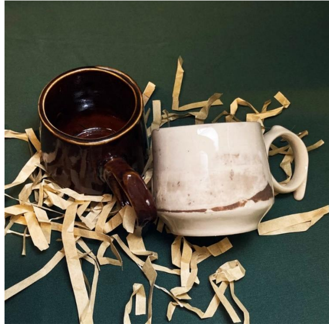
Görsel 3.30. Döküm yöntemi ile şekillendirme, ÇS25 kodlu sır ve Çakıl atık katkılı mermer desen-saydam sır, daldırma yöntemi, 1200 °C (Özkul, 2022)
