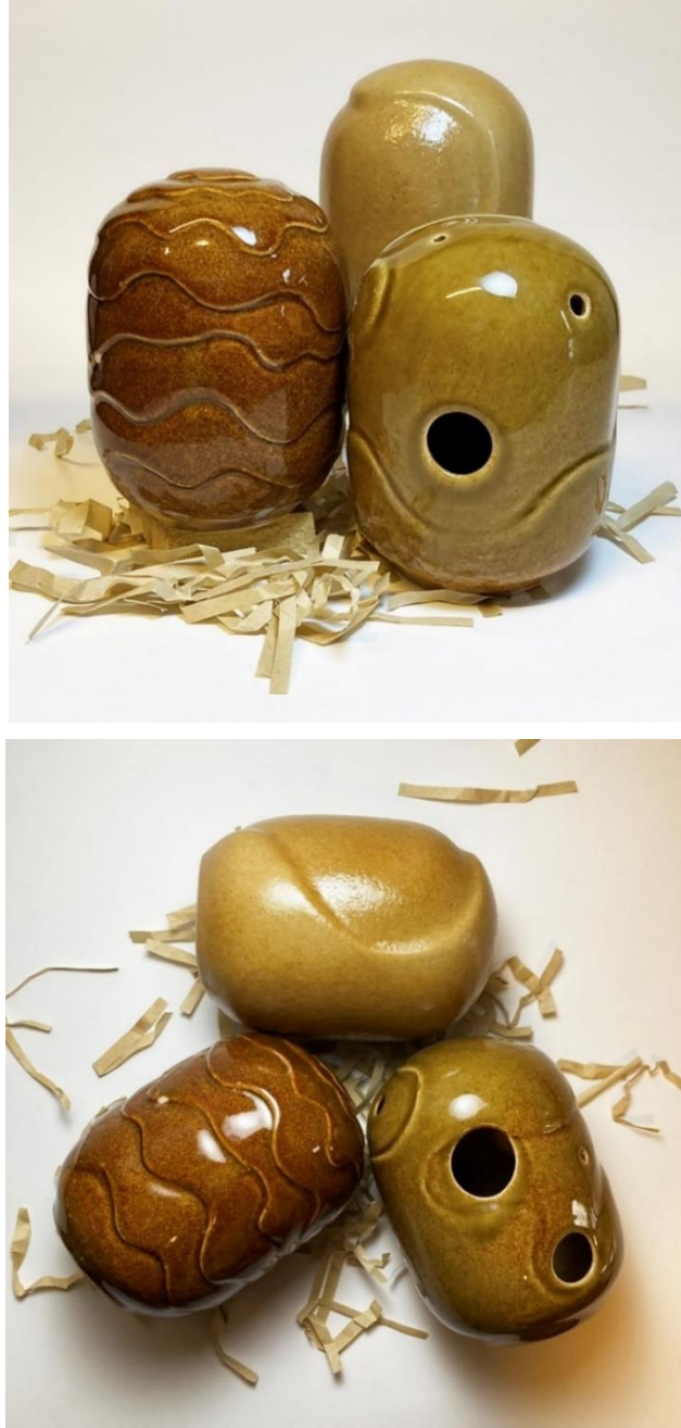
Görsel 3.41. Döküm yöntemi ile şekillendirme ÇS18 (sağ), ÇS27 (sol), kodlu ve ÇM6-%3 MnO kodlu (üst) sırlar, püskürtme yöntemi, 1200 °C (Özkul, 2023)
