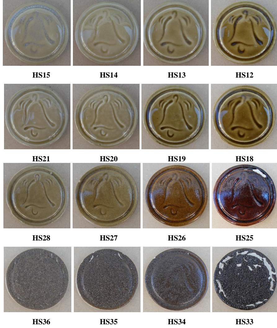
Görsel 3.14. Çan taşı havuz atığı-üleksit-kırmızı kil üçlü sistemindeki sırların 1200 °C'deki pişirim sonuçları
