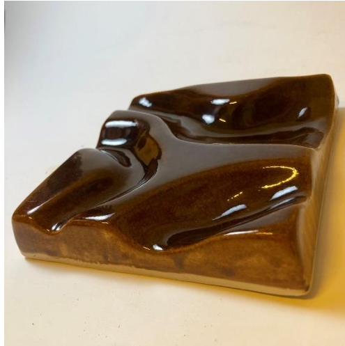
Görsel 3.40. Döküm yöntemi ile şekillendirme, ÇS25 kodlu sır, püskürtme yöntemi, duvar karosu, 1200 °C (Özkul, 2023)
