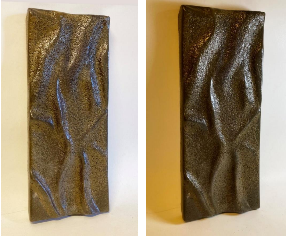
Görsel 3.36. Döküm yöntemi ile şekillendirme ,HS6-%3 Fe 2 O 3 kodlu sır , püskürtme yöntemi, duvar karosu, 1200 °C (Özkul, 2023)
