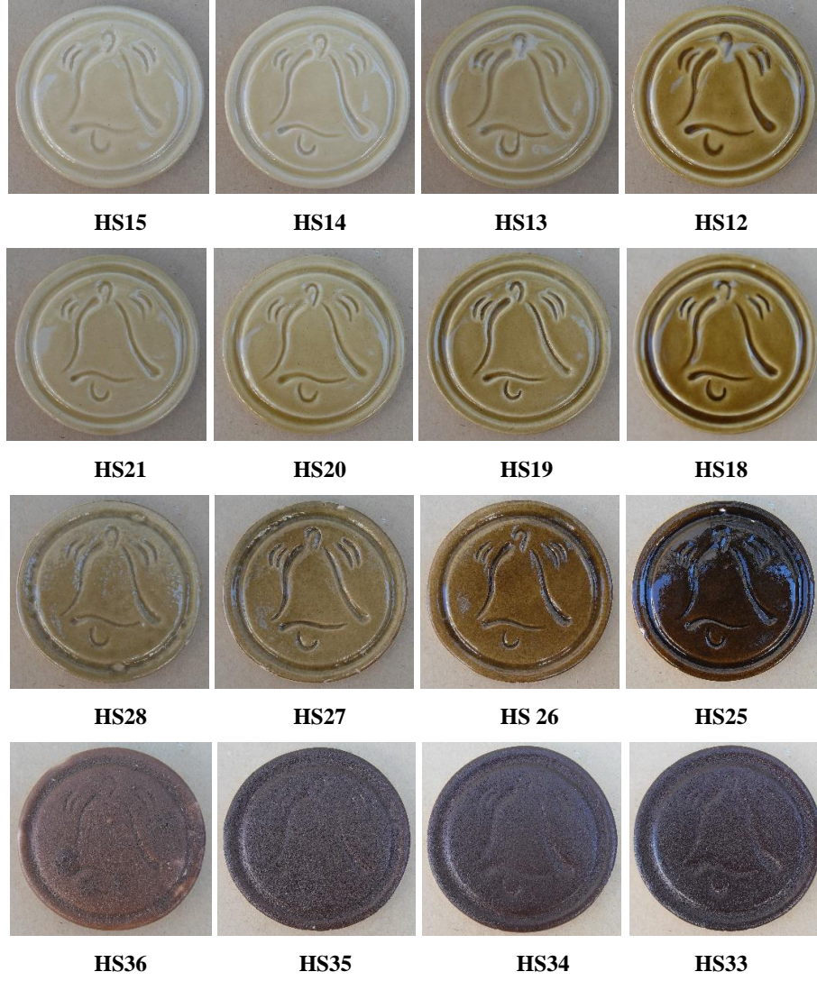
Görsel 3.13. Çan taşı havuz atığı-üleksit-kırmızı kil üçlü sistemindeki sırların 1160 °C'deki pişirim sonuçları
