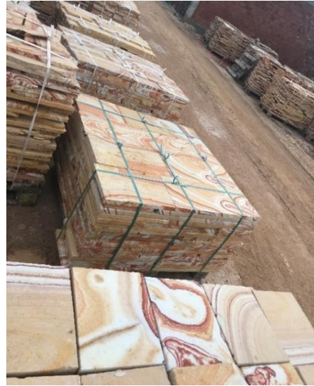
Görsel 2.7. Ocaktan çıkarılan Çan taşı bloklarının plaka ve blok kesim için ayrılması işlemi (Özkul, 2022)
