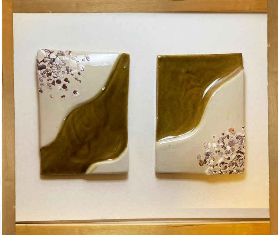
Görsel 3.38. Döküm yöntemi ile şekillendirme, ÇS18, ÇS27 kodlu sırlar. Çakıl atık karışık uygulama, akıtma yöntemi, duvar karosu, 1200 °C (Özku, 2023)
