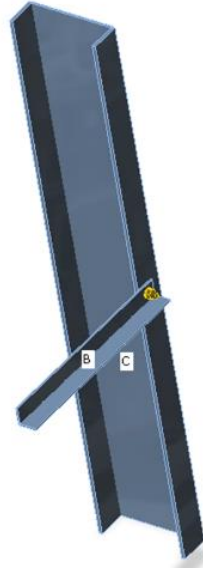
Şekil 3.23. Kafes elemanda guse plakası bağlantısı sadece N , V_y , V_z kuvvetlerini akataran birleşim [69]
