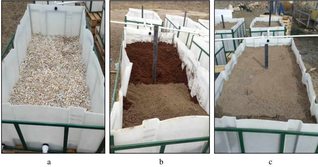
řekil 2.6. Yapay sulak alanlarda kullanılan filtrasyon ve dolgu malzemeleri: akıl (a), kum (b) ve torf (c)
