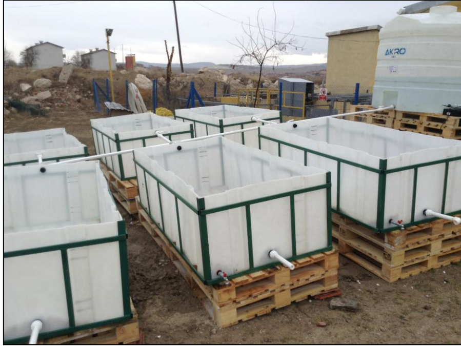
Şekil 2.3. Yapay sulak alanların kurulacağı polyster düzenekler
