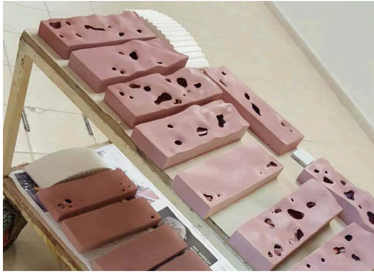
Görsel 3.4. Sırlama işlemi sonrası seramik birimler
