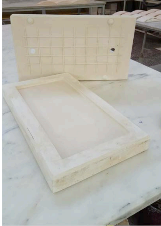
Görsel 3.11. 30 x 40 ebatlarında alçı üretim kalıbı
