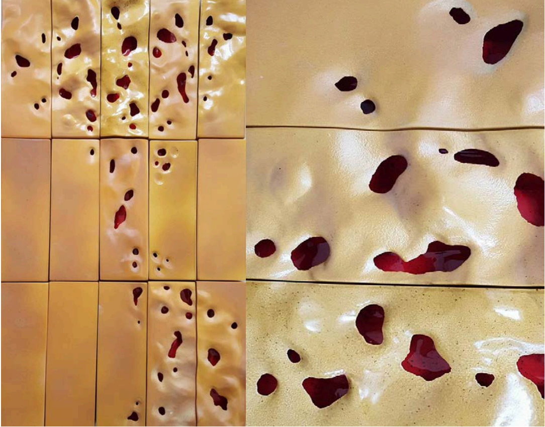
Görsel 3.5. 1060 °C'de fırınlanmış seramik birimler
