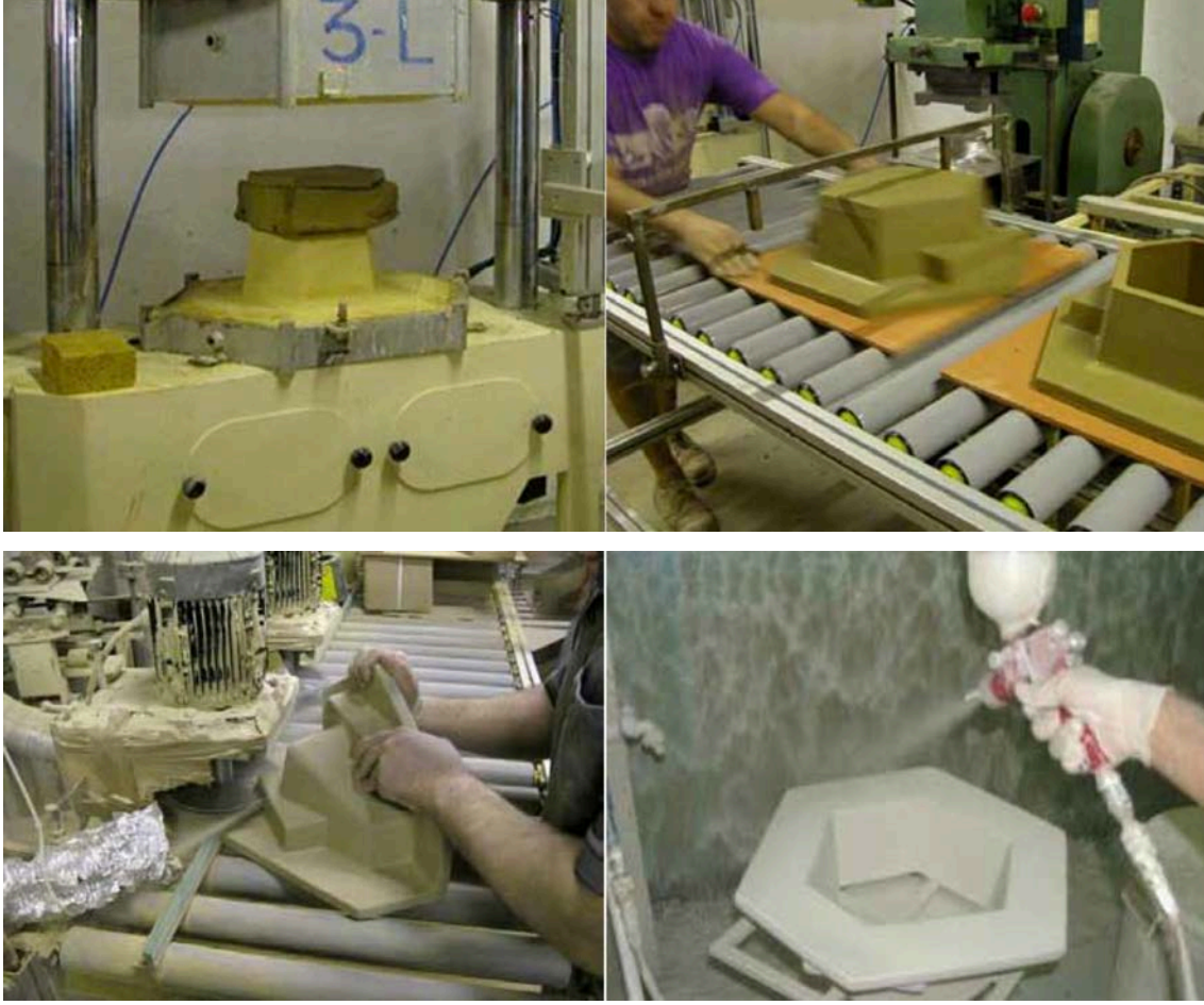
Görsel 2.32. Seramik birimlerin preslendikten sonra ki kesim ve sır aşamaları
