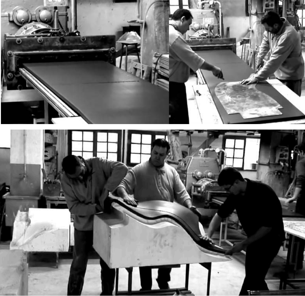
Görsel 2.30. Çamur plakanın kesim ve kalıp içerisine yerleştirilerek çökertme işleminin yapımı
