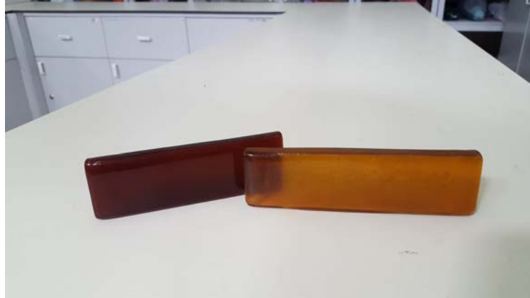
Görsel 3.15. Kalıplar içerisinden çıkartılan 1,3 cm kalınlığında renkli cam kütleler
