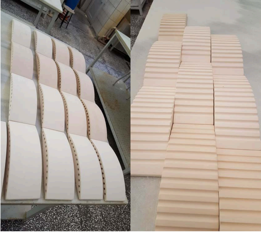
Görsel 3.8. Seramik döküm yöntemiyle çoğaltılan birimlerin 900 °C'de bisküvi pişirimi yapılmıştır.
