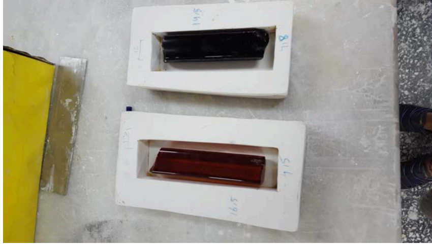
Görsel 3.14. Kalıplar içerisine yerleştirilen kütle camlar
